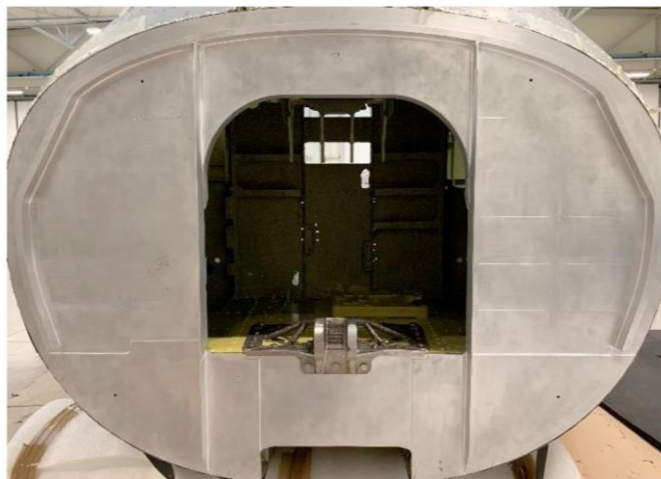
Figura II-4. Panel aeronáutico fabricado por mecanizado mecánico a partir de un solo bloque inicial. Fuente: [Balon, 2020].
