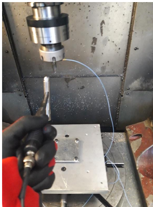
Figura IV-8. Test de impacto en la herramienta.
