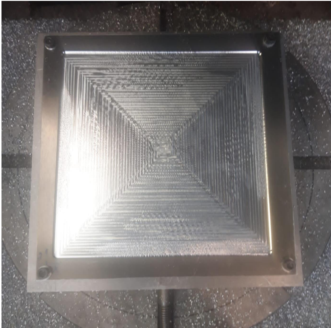
Figura IV-13. Placa de área 225x225 mm 2 ya fresada.
