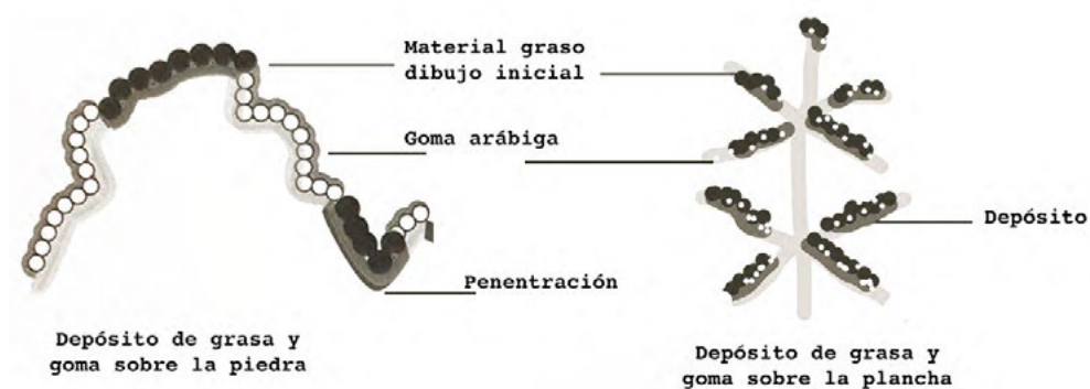
Figura 6. Gráfico comparativo de los depósitos del material graso sobre el grano de la piedra y sobre el grano del acero. Fuente: Imagen de la autora.
