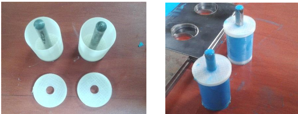
Figura 3.10 Moldes impresos y colada de silicona para la fabricación de probetas de conductividad térmica.
