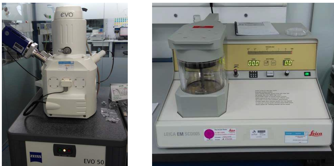
Figura 3.9 Microscopio de barrido SEM-EDX y equipo de Sputtering .
