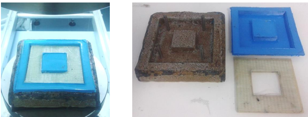
Figura 4.11 Introducción del laminado de fibra continua en el molde y desmoldeo de la funda y pieza.
