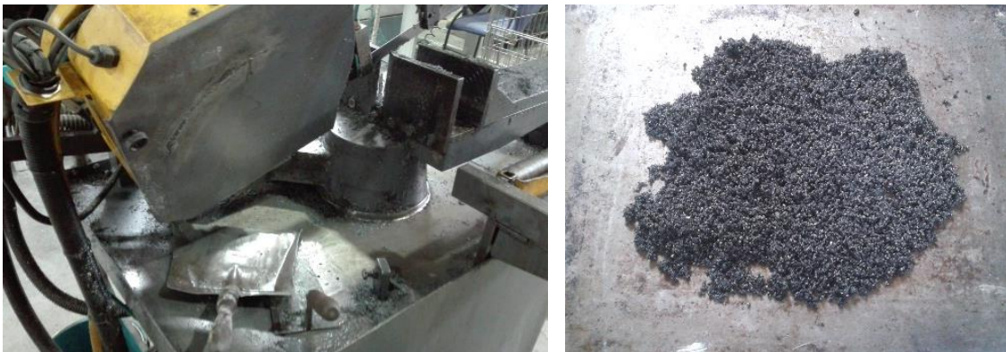
Figura 3.1 Sierra de cinta (izquierda); microviruta de acero (derecha).
