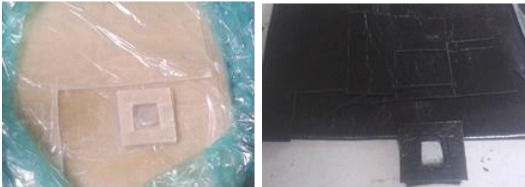
Figura 3.27 Preimpregnado vinilester-epoxi con tejido de fibra de vidrio (izquierda) y preimpregnado poliéster con mat de fibra de vidrio (derecha).
