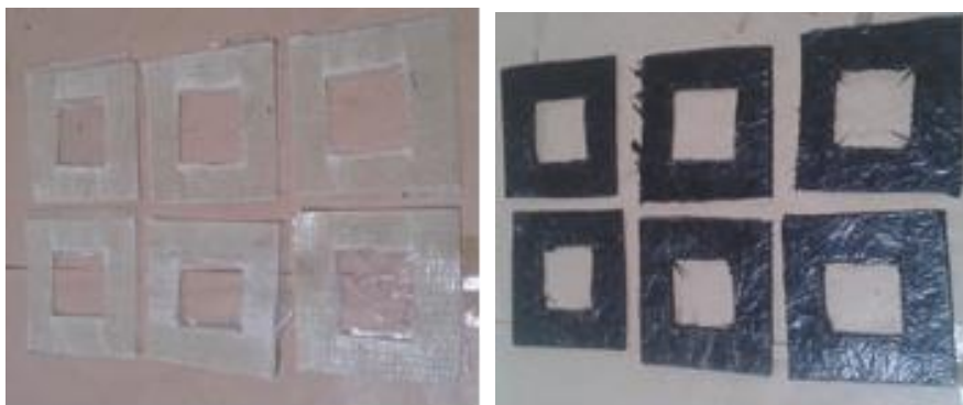
Figura 3.28 Patrones de preimpregnado vinilester-epoxi (izquierda) y poliéster (derecha).
