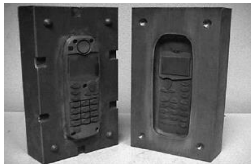
Figura 2.23 Moldes de una carcasa de teléfono [171].
