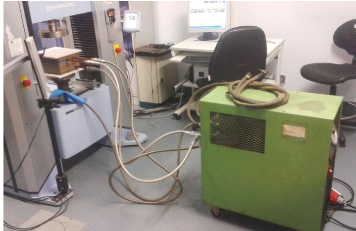
Figura 3.31 Montaje del molde en la máquina de ensayos universales acoplado al calentador de aceite.
