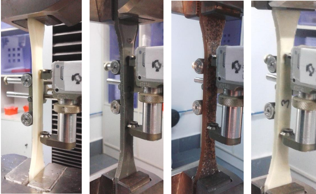
Figura 3.13 Ensayo para la determinación de la resistencia máxima y módulo elástico en tracción de 4 de los 17 compuestos diferentes.
