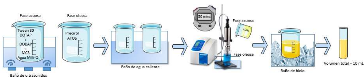
Figura 5. Elaboración de SLN por el método de homogeneización en caliente (HM).
