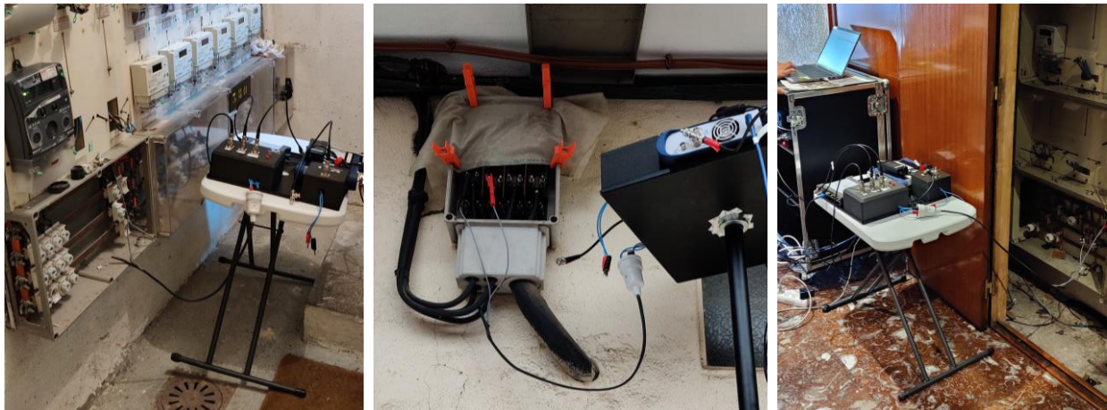
Figura 1. Medidas de campo en diferentes puntos usando un cable apantallado de 1m.
