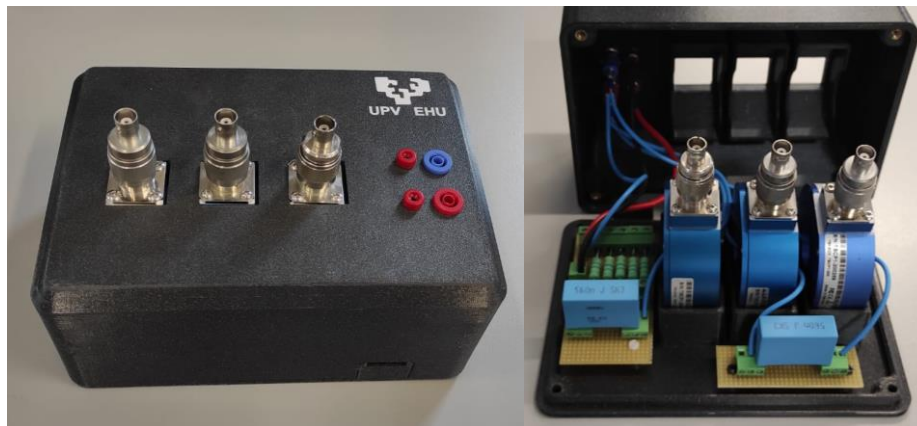
Figura 47. Nuevo sistema de medición de impedancias de red – Caja de sondas de corriente.
