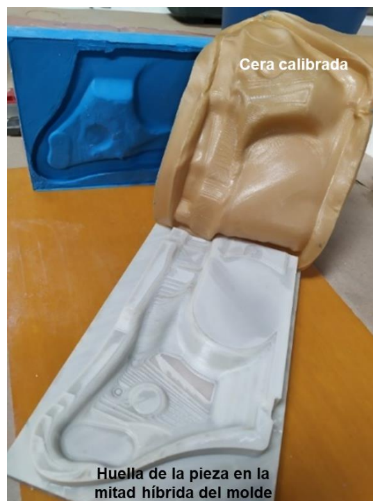
Figura 83. Molde híbrido. Zona híbrida PC/ABS/resina (color blanco) – contra molde de silicona (color azul) – cera calibrada (color beige)
