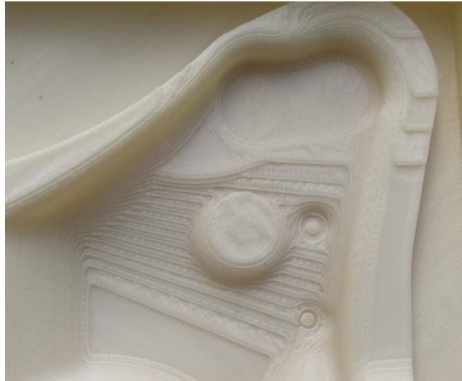
Figura 74. Detalle de zona de la superficie del molde impreso (anchura de extrusión 0,4mm, altura de capa 0,4 mm, espesor de piel 0,6 mm, relleno 12,5 % rectangular)
