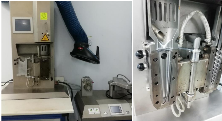
Figura 1. Izquierda: microcompounder. Derecha: cámara de mezcla abierta con husillos cónicos contrarrotantes
