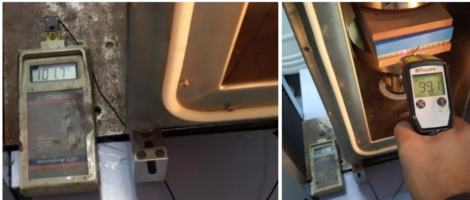
Figura 87. Temperatura en el interior del molde al final de proceso de compresión 101,7 °C. Temperatura de la base del molde 99,1 °C (experimento 5)
