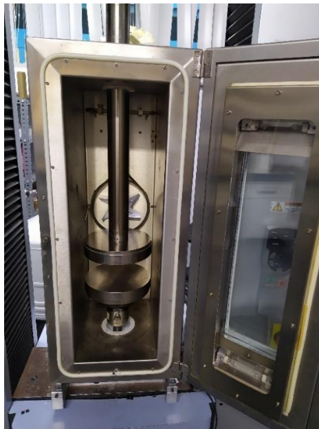
Figura 14. Cámara térmica acoplada a máquina universal de ensayos
