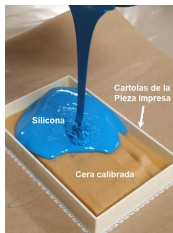
Figura 78. Obtención del contra molde por colada de silicona
