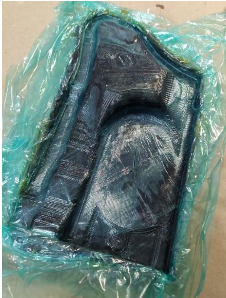
Figura 91. Pieza moldeada de composite junto con el film de desmoldeo
