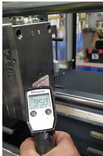
Figura 69. Registro de la temperatura en el inserto híbrido de PPS después del desmoldeo de la pieza inyectada
