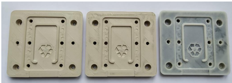
Figura 67. a) parte trasera de los insertos. b) huella de los insertos híbridos. Izquierda y centro: PPS, derecha: PC/ABS
