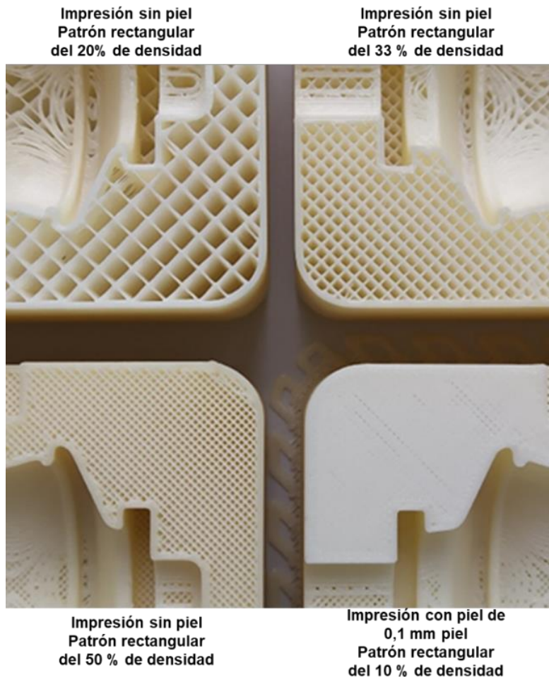
Figura 5. Aspecto de la huella de la pieza impresa en función del espesor de la piel y la densidad del patrón de relleno
