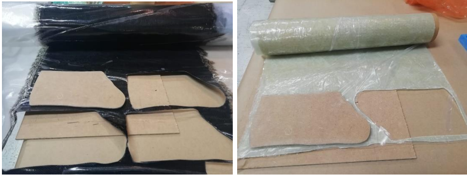
Figura 84. Troquelado de preformas de preimpregnado de moldeo
