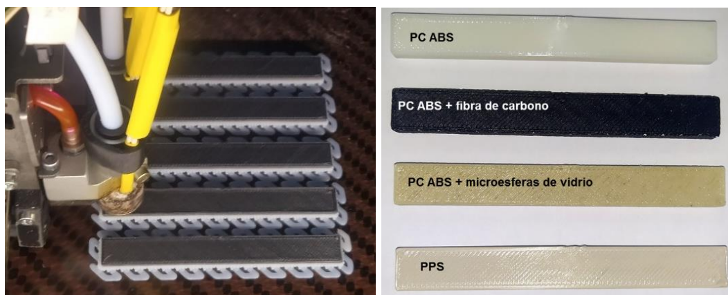
Figura 23. Izquierda: proceso de Impresión de probetas de PC/ABS reforzado con fibras de carbono (T. 270 °C). Derecha: probetas de 80 mm x 10 mm x 4 mm de espesor con distinta composición
