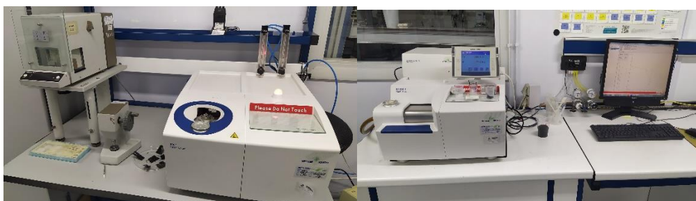
Figura 15. Calorímetro Mettler Toledo para ensayos de TG y DSC
