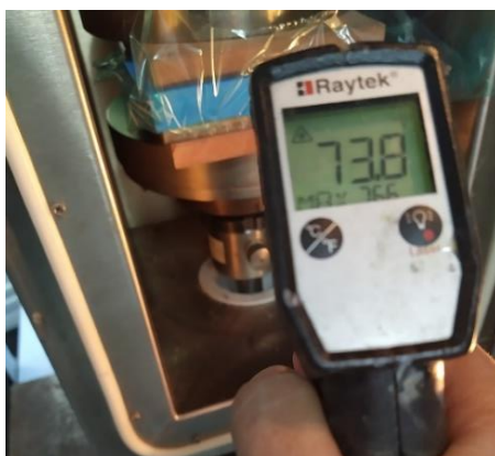
Figura 86. Medida con termopar de infrarrojos del molde colocado en el interior de la cámara térmica (experimento 3)
