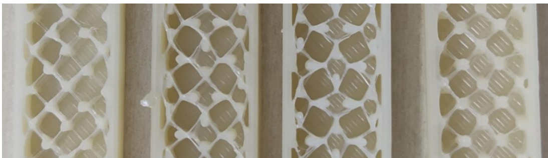
Figura 15. Patrones al 25% de densidad. De izquierda a derecha: rectangular, octogonal, redondeado y celular
