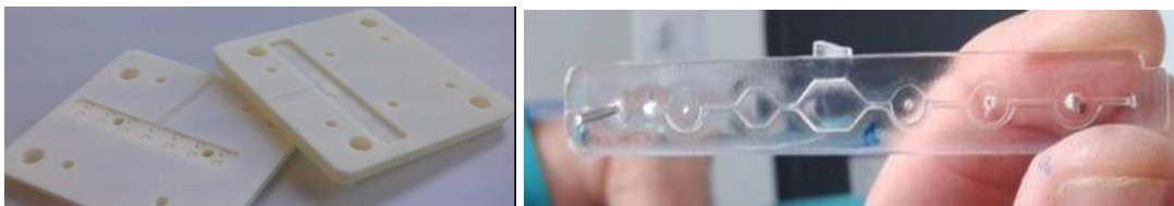
Figura 36. Izquierda: Moldes de poliamida obtenidos con tecnología de sinterizado laser. Derecha: Pieza con micro canales, inyectada con material definitivo (GAIKER)
