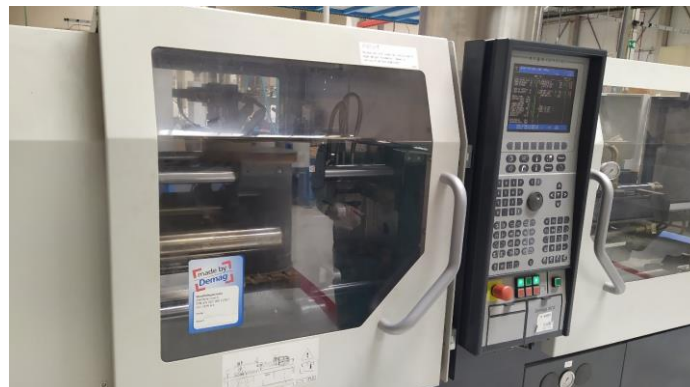
Figura 12. Inyectora Demag Concept 25/280 -35
