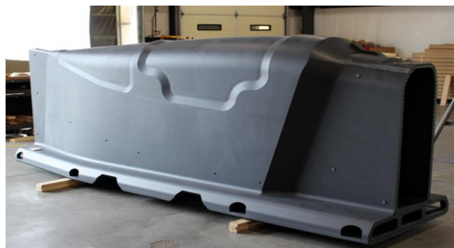
Figura 39. Utillaje fabricado con tecnología LSAM (Boeing part. © Thermwood Corporation)
