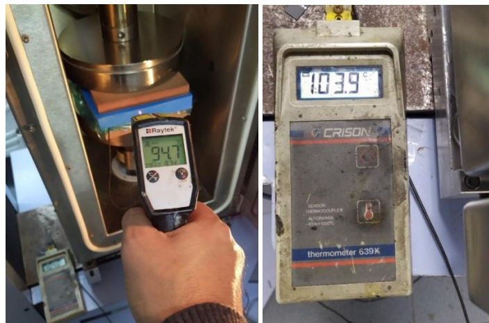
Figura 88. Temperatura del interior del molde al final del proceso de moldeo 103,9 °C (experimento 6)
