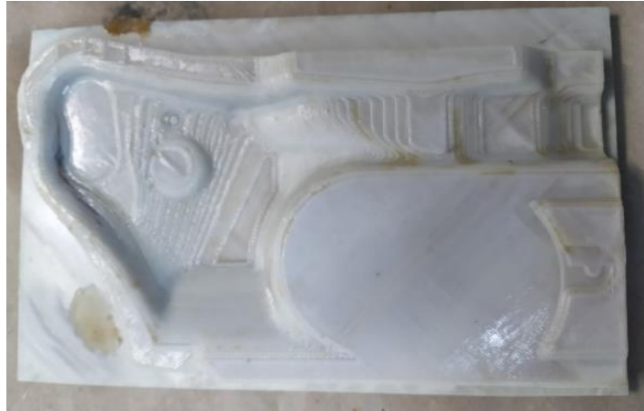
Figura 92. Aspecto de la parte híbrida del molde PC/ABS-Resina termoestable después de las pruebas de moldeo
