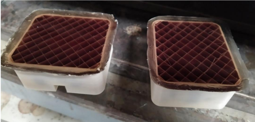
Figura 7. Pieza híbrida mediante colada de resina y postcurado a 60 °C durante 6 horas
