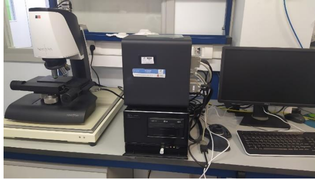
Figura 19. Perfilómetro Confocal PL \mu NEO
