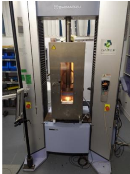
Figura 21. Máquina universal de ensayos
