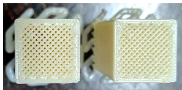
Figura 3. Probetas impresas con piel de 0,1 mm, relleno rectangular del 50%. Altura de capa 0,3 mm (experimento 14)
