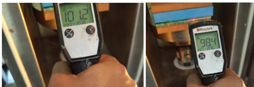
Figura 90. Temperatura en el exterior del molde. Izquierda contra molde de silicona (101,2°C). Derecha molde PC/ABS-Resina (98,4°C)
