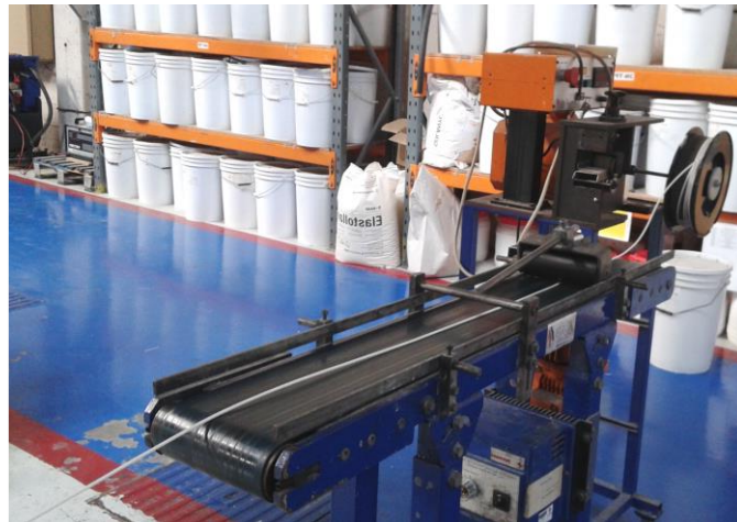
Figura 4. Arrastre del filamento con cinta transportadora y bobinadora.
