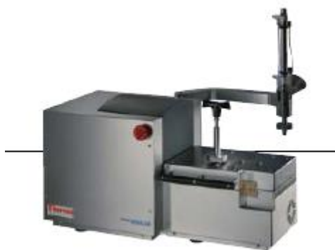
Figura 16. Equipo Minilab Haake Rheomex CTW5
