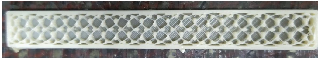
Figura 12. Patrón octagonal del 25% de densidad
