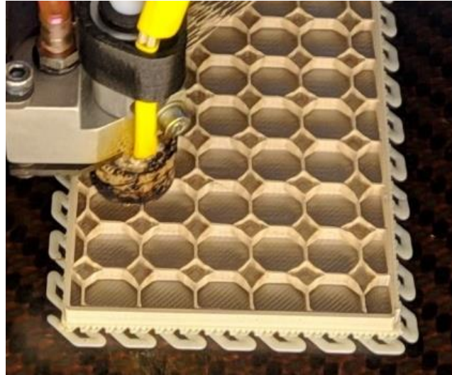
Figura 16. Patrón octogonal con densidad del 10%
