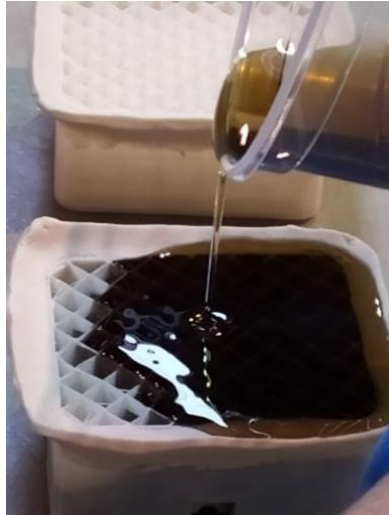
Figura 10. Colada de la formulación en los insertos impresos de PC/ABS
