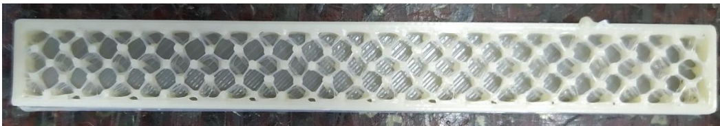
Figura 14. Patrón celular del 25% de densidad
