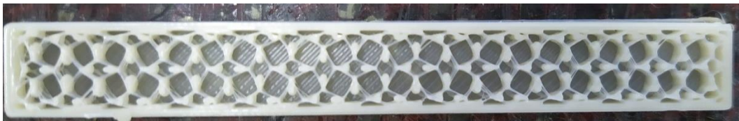
Figura 13. Patrón redondeado del 25% de densidad
