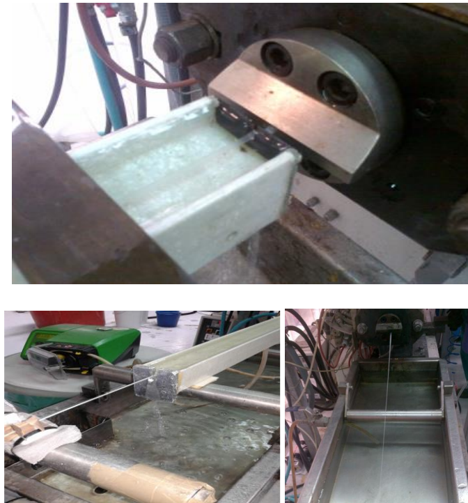
Figura 3. Salida horizontal y refrigeración con agua del filamento termoplástico
