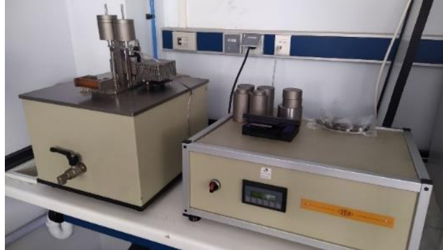
Figura 20. Equipo de caracterización Vicat
