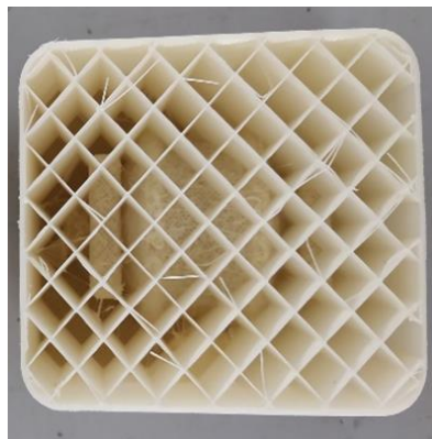
Figura 9. Base de la pieza impresa con patrón de relleno rectangular del 10% de densidad
