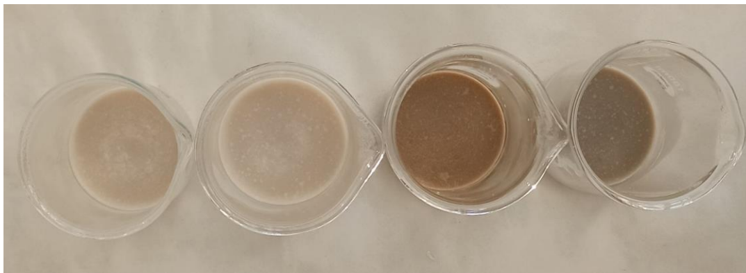
5.12. Irudia. Despolimerizazio-erreakzioetan lortutako produktu glikolizatuaren irudia, PET-v, PET-ssp, PET-u eta PET-m (ezkerretik eskumara).
