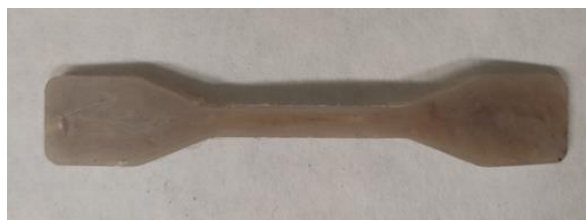
6.8. Irudia. Termo-mekanikoki birziklatutako RTPU lagin injektatua.
