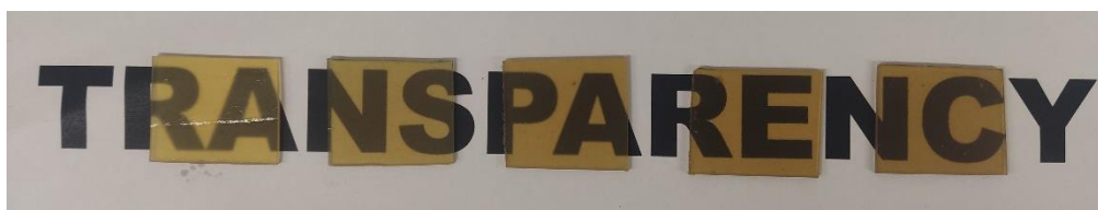
7.1. Irudia. PU termoeogonkorrek, ezkerretik eskuinera BHET edukia handituz.
