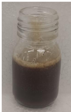
6.14. Irudia. TPU laginen glikolizatik lortutako TPU-Gly lagina.
