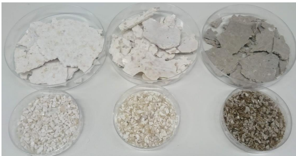
4.7. Irudia. Beheko aldean ehotutako lakin birziklatuak eta goiko aldean horietatik abiatuta konpresio-moldeaketaz lorturiko laginak, ezkerretik eskumara RPET-ssp, RPET-u eta RPET-m laginak.
