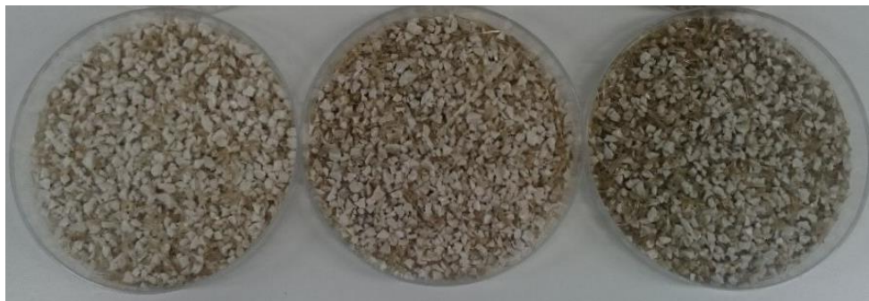
4.9. Irudia. RPET laginen konposizio ezberdinak, ezkerretik eskumara 90u/10m, 80u/20m eta 70u/30m.
