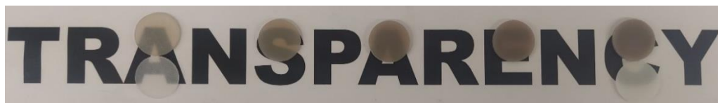
6.1. Irudia. TPU ezberdinen irudi digitala, BHET-m seriea (goian) eta BHET-ref seriea (behean) kate-luzatzaile gisa erabiliz.
