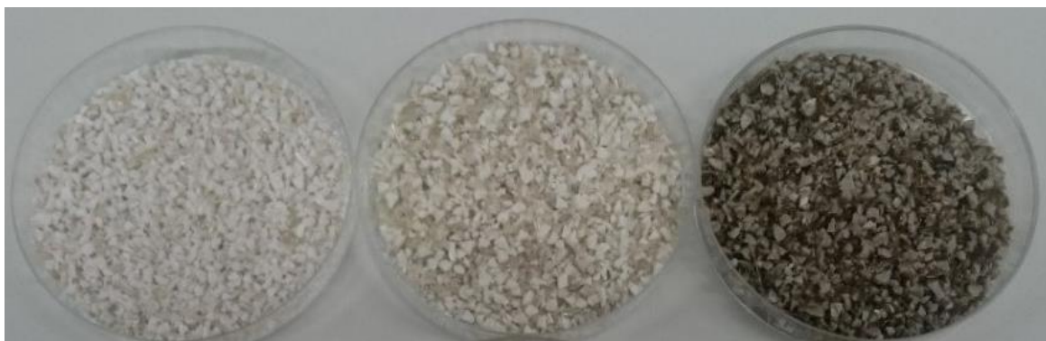
4.2. Irudia. Birziklatze termo-mekanikoaren ondoren txikitutako PET laginak ezkerretik eskumara: RPET-ssp, RPET-u eta RPET-m.
