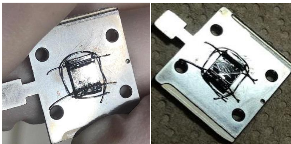
Figura 21. Foto de portamuestras de Molibdeno con una fracción de 0.5mm x 0.4 mm de grafito-HOPG sujeta con tiras de Tántalo tras realizarle una limpieza superficial mediante la técnica exfoliado.
