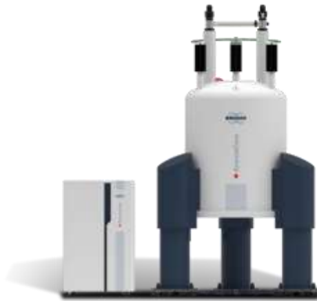
15. Irudia 500 MHz-ko "Bruker Avance NMR" instrumentua.
