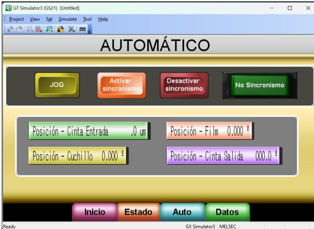
Figura 44: Interfaz máquina-humano, pantalla de Automático
