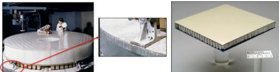
Figura 2.- a) Espejo primario del HST. b) Detalle de la estructura de Honeycomb de aluminio [2]. c) Muestra de laboratorio de Nasa-Lewis Research Center [3]. [Fuente: NASA]
