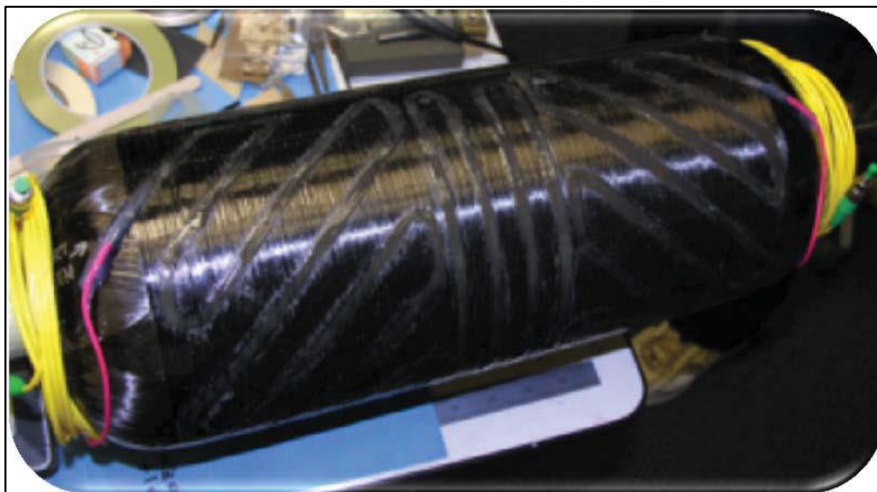
Figura 21.-: Instrumentación del COPV con sensores de FO embebidos a 500psi. [41]. [Fuente NASA].
