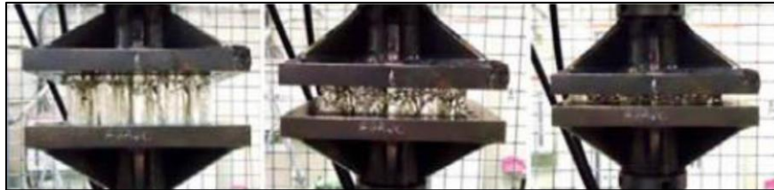
Figura 8.- Ensayos de compresión sobre panel de honeycomb de aluminio de la misión Exomars [12]. [Fuente: SENER AEROESPACIAL]
