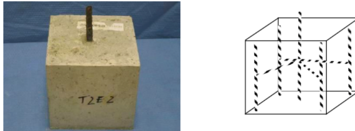
Figura 37: Apariencia externa de las muestras y disposición interna de las barras de refuerzo.
