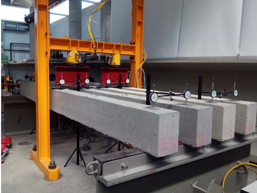
Figura 22. Disposición de las vigas en el ensayo de deformación a largo plazo.
