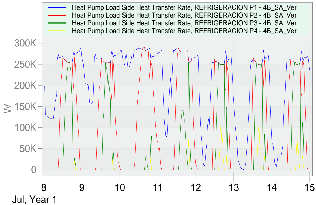
Figura 28: Curvas de potencia de bombas de calor sin almacenamiento en semana de verano
