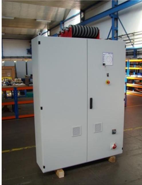
Figura 19. Convertidor para sistemas de baterías de 100 kW [33]
