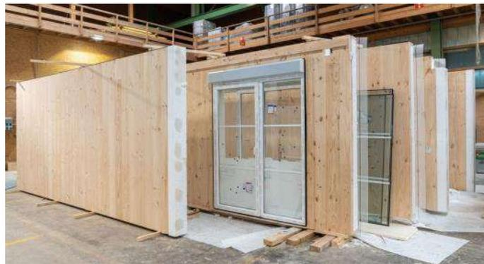
Ilustración 25: Ventanas y puertas en fachadas de CLT
