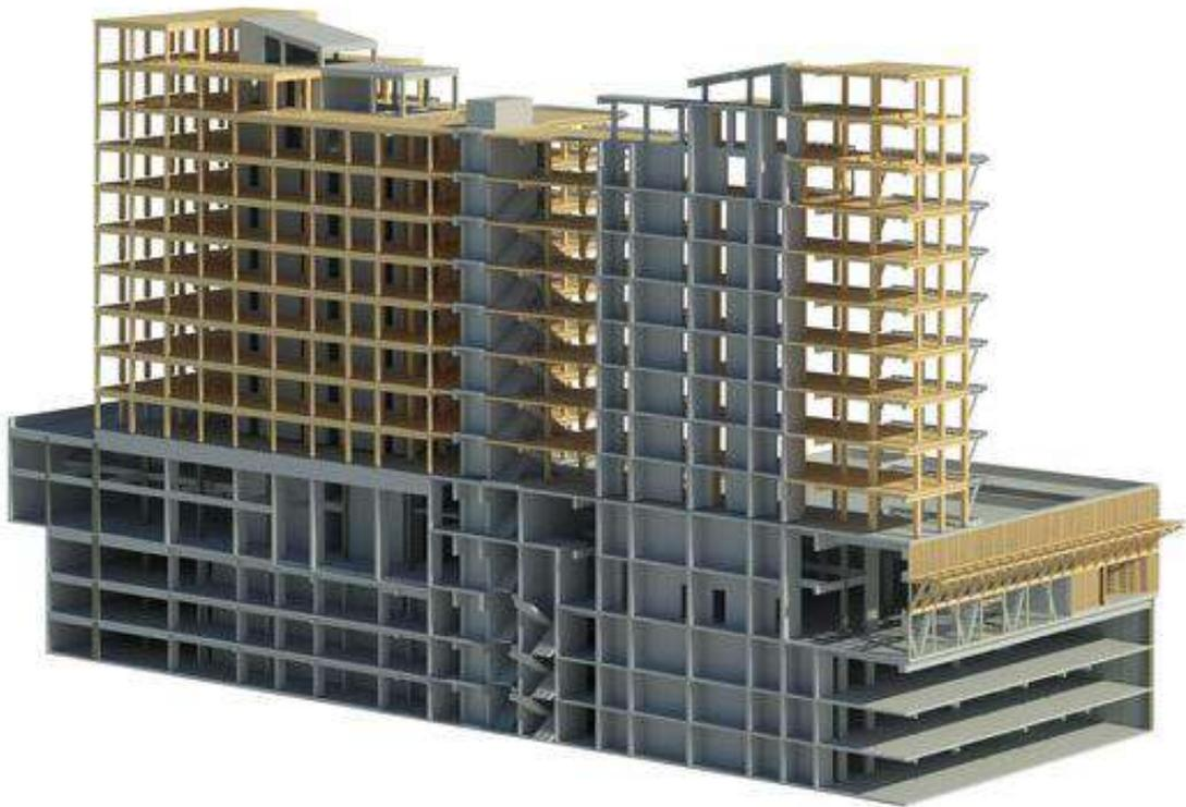
*Ilustración 18: Primer edificio en altura de CLT de América Latina*
