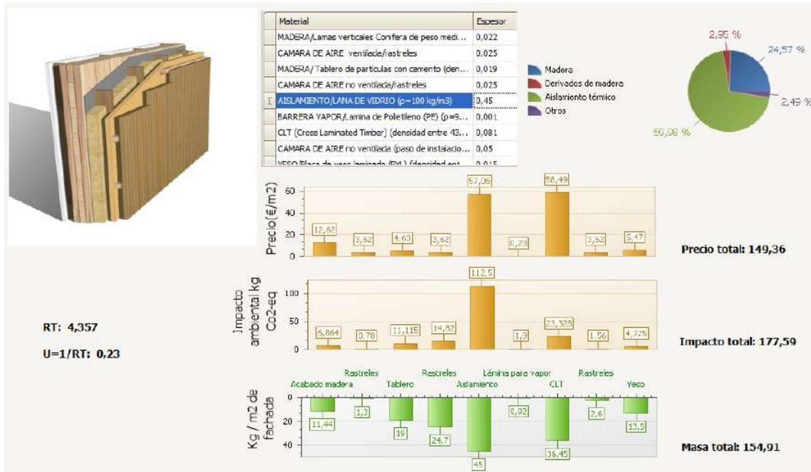
Ilustración 84: CLT con acabado exterior de lamas
