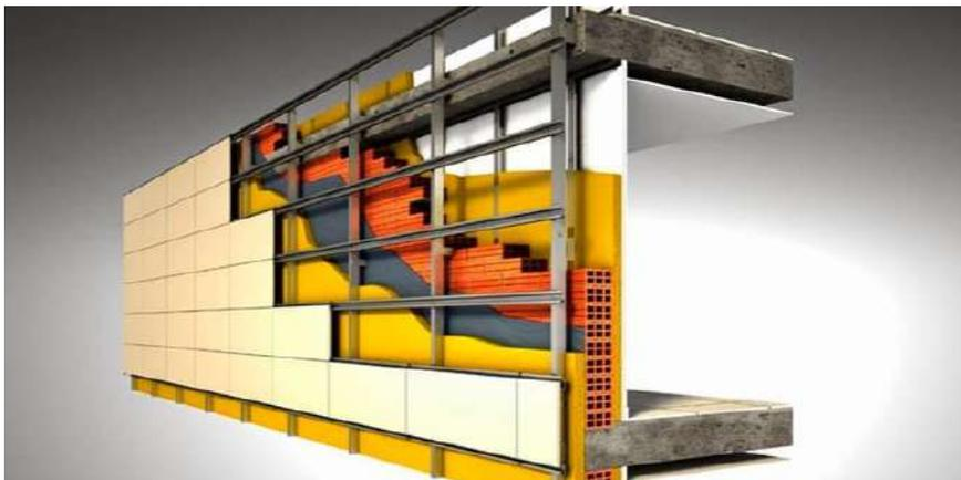
*Ilustración 13: Sistema de fachada ventilada*
