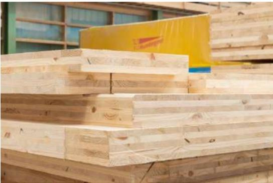
*Ilustración 46: Composición y estructura del CLT*
