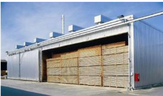
Ilustración 20: Cámara de secado de madera
