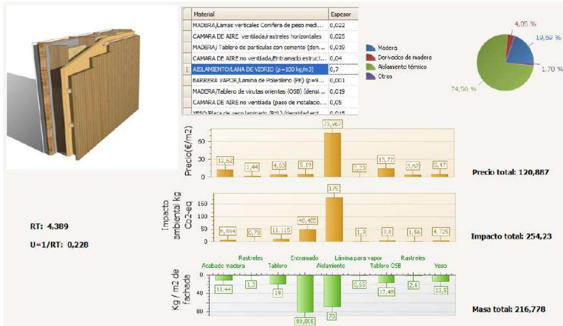
Ilustración 83: Entramado Ligero con acabado exterior de lamas
