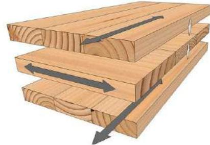
*Ilustración 21: Capas de tabla CLT*
