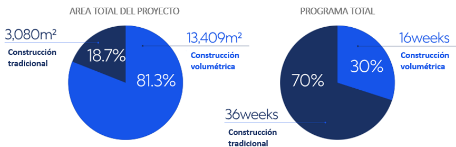
Ilustración 26 - Características de la construcción de Apex House.
