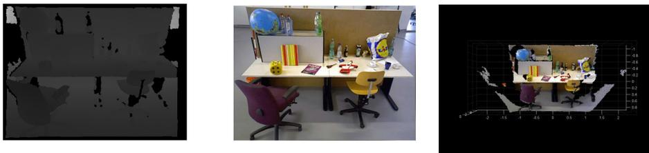
*Ilustración 3. Imagen de profundidad, a color y reconstrucción de nube de puntos*
