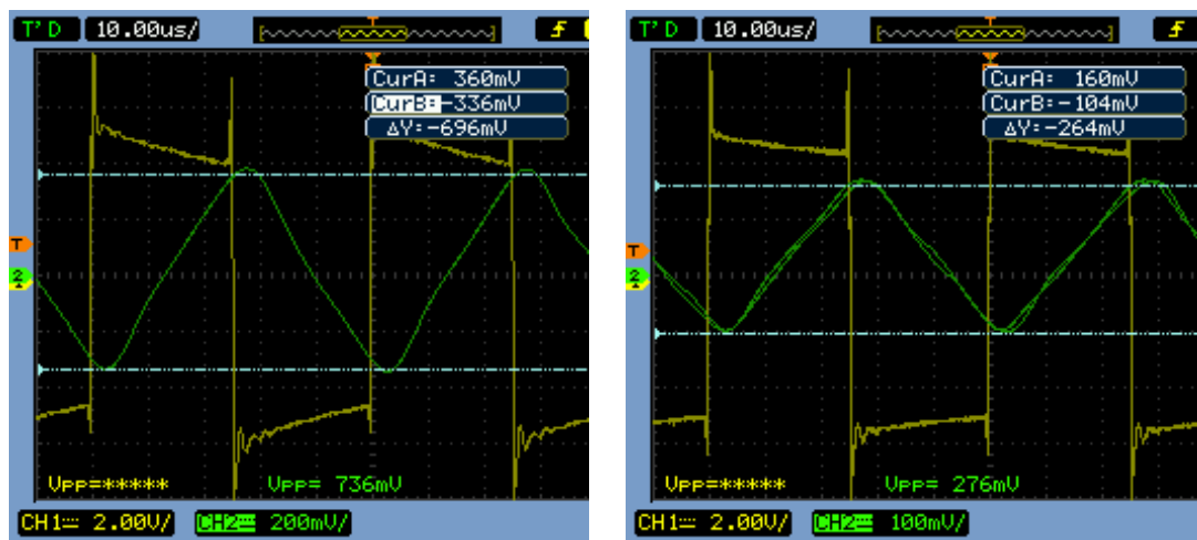
FIGURA 77: SEÑALES OBTENIDAS CON EL CONVERTIDOR. A) SECUNDARIO EN CIR. ABIERTO. B) PRIMARIO EN CIR. ABIERTO.
