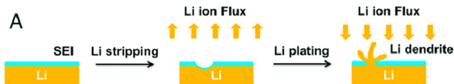
Ilustración 8. Diagrama esquemático del comportamiento del plating/stripping del Li para electrodos de Li metálico en donde se ve el cambio de volumen durante el stripping/plating de Li el cual provoca el fallo de SEI y el crecimiento de dendritas de Li [73].
