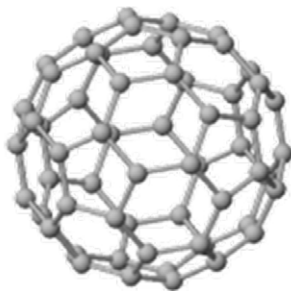
2. irudia. Fullerenok C_{60} , hogen hexagonoz eta hamabi pentagonoz osatuta [3].
