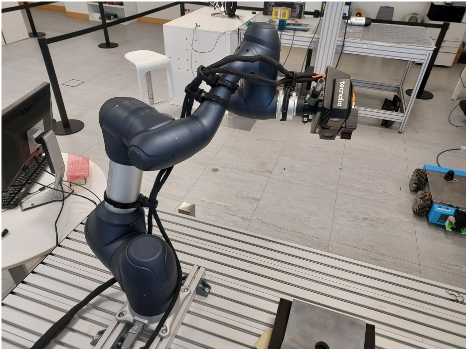
Figura 1.1: Brazo robótico colaborativo Doosan con una cámara 3D de luz proyectada Zivid.
