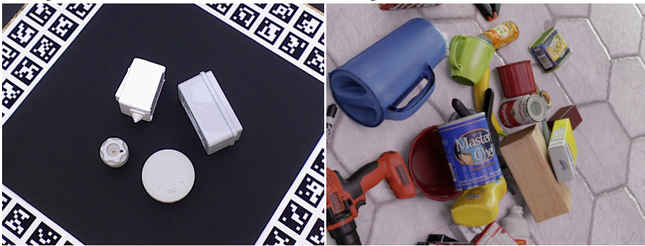
(c) Imagen real del dataset TLESS perteneciente al BOP challenge. (d) Imagen sintética generada con la herramienta del BOP challenge para el dataset YCBV.
