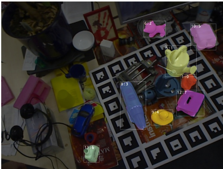
Figura 1.2: Estimación de la pose de los objetos del dataset Linemod proyectada sobre una imagen de test.
