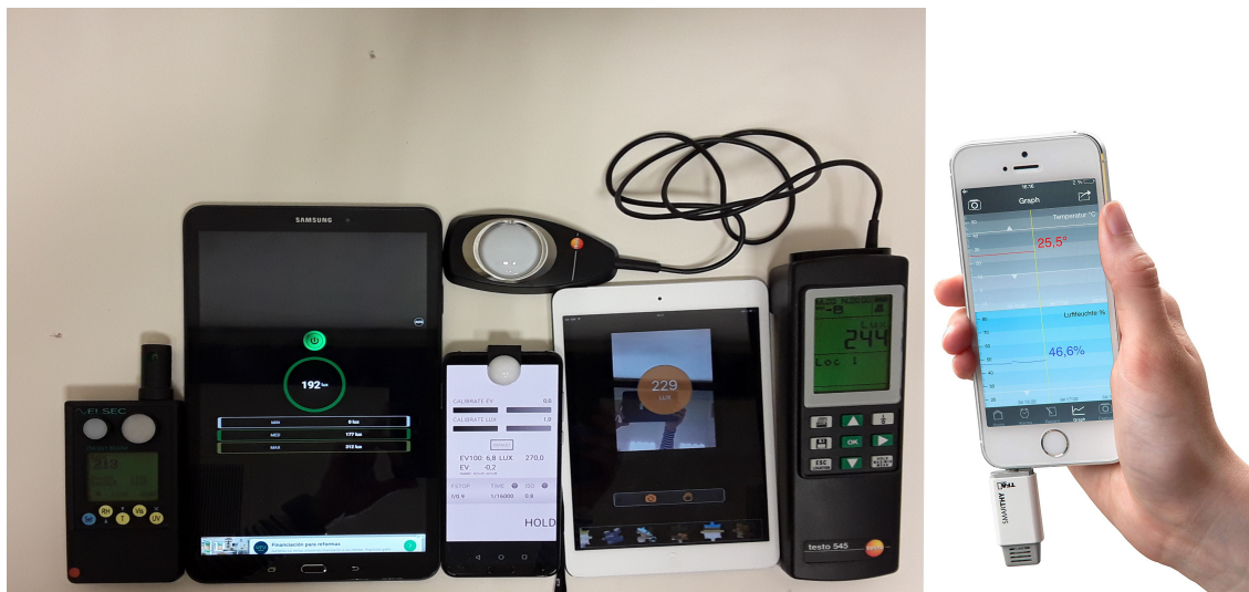
Ilustración 6. (Izqda.) Comparativa entre equipos generalmente empleados en el control de parámetros de conservación y apps móviles: Luxómetro calibrado, dispositivo con medidor de lux con el dispositivo LUXIT™ y otras apps. Elaboración propia. (Dcha.) Termohigrómetro Smarthy TFA adaptable a entradas con USBc o micro en dispositivo Apple. TFA Dostmann GmbH & Co.
