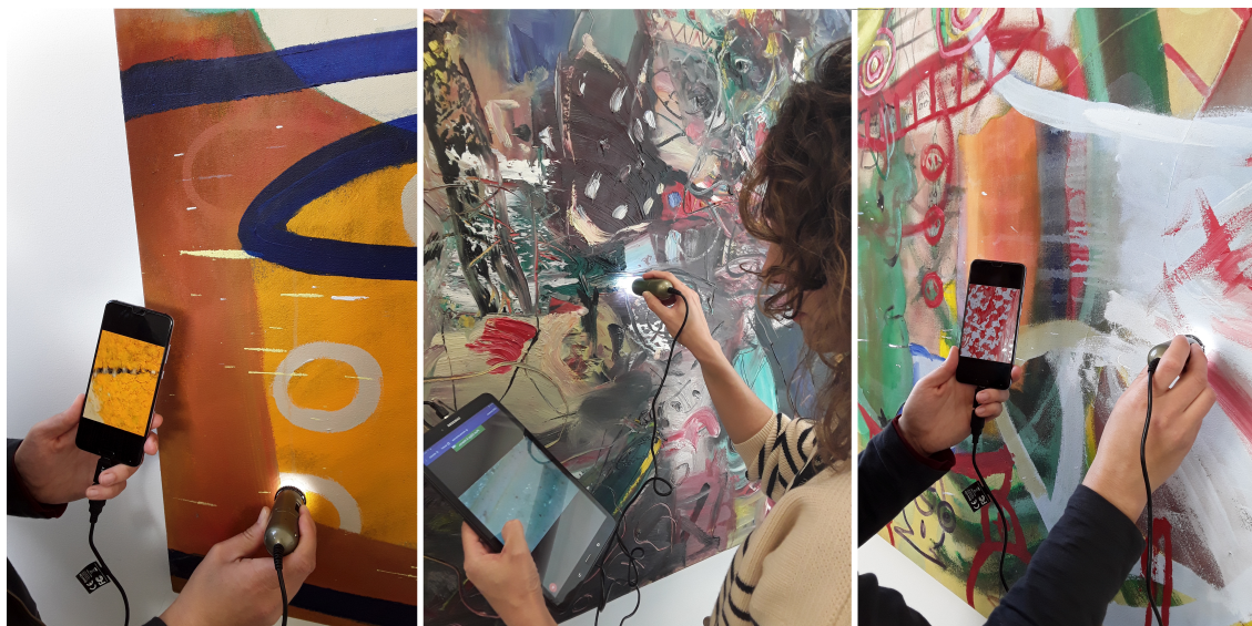
Ilustración 5. Visionado de las características y deterioros presentes en superficie de diferentes obras pictóricas de la colección mediante el microscopio digital adaptado a diferentes dispositivos móviles. Elaboración propia.
