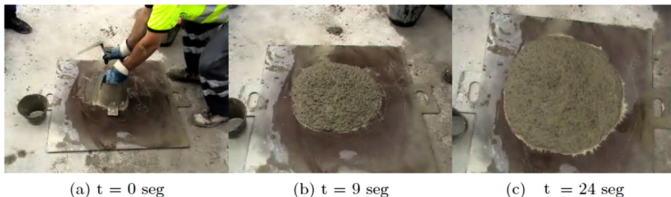
Figura 9. Ensayo de escurrimiento de amasada en laboratorio.
