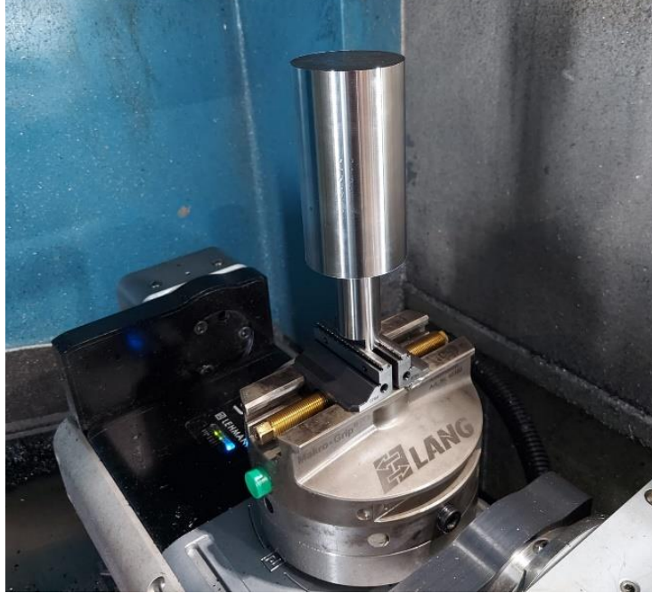
Figura IV-20: Disposición del tocho inicial de partida del compresor de tornillo sin fin macho simétrico.
