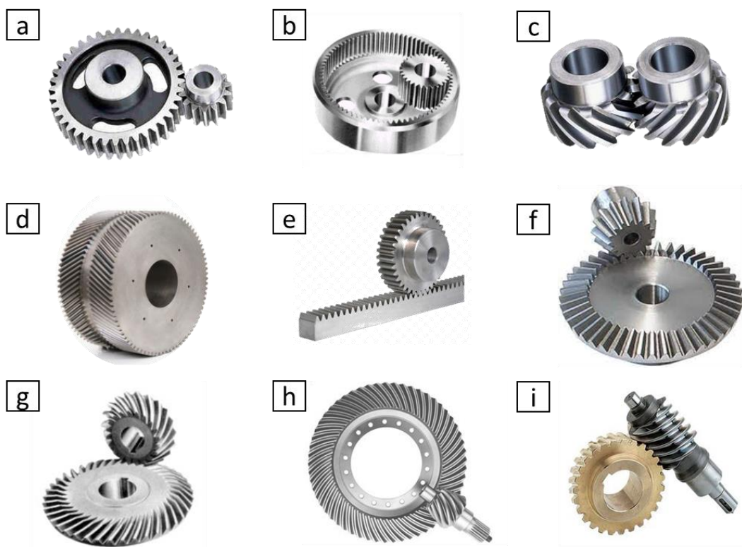
Figura II-13 Distintos tipos de engranajes: a) Engranaje cilíndrico de dientes rectos externos, b) Engranaje cilíndrico de dientes rectos internos, c) Engranaje cilíndrico de dientes helicoidales, d) Engranaje cilíndrico de dientes helicoidales en espiga, e) Piñón cremallera, f) Engranaje cónico de dientes rectos, g) Engranaje cónico de dientes helicoidales, h) Engranaje hipoide y i) Engranaje o compresor de tornillo sin fin.
