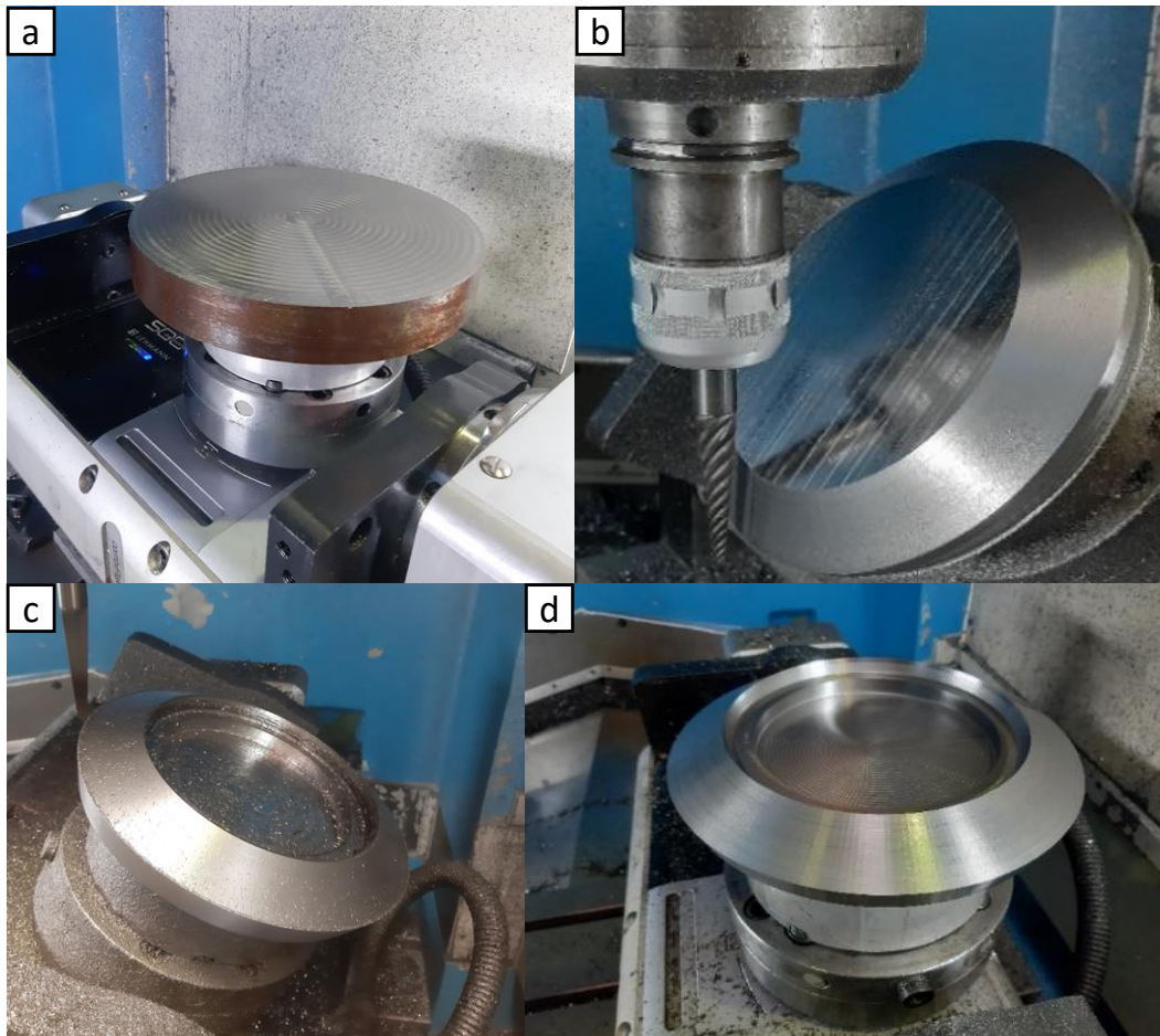
Figura IV-13: Proceso de preparación del tocho para el engranaje espirocónico: a) Planeado de la cara superior, b) Mecanizado de la cara cónica superior, c) Mecanizado de la cara cónica inferior y d) Mecanizado y acabado de cavidad circular central.
