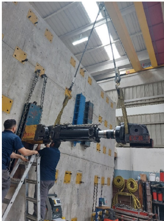
Figura 68. Pistón hidráulico utilizado para someter a carga el espécimen MURO
