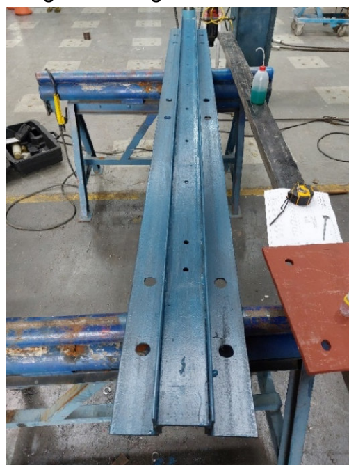
Figura 52. Viga de cimentación
