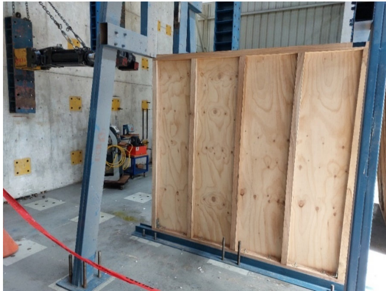
Figura 60. Colocación de muro en piso de reacción
