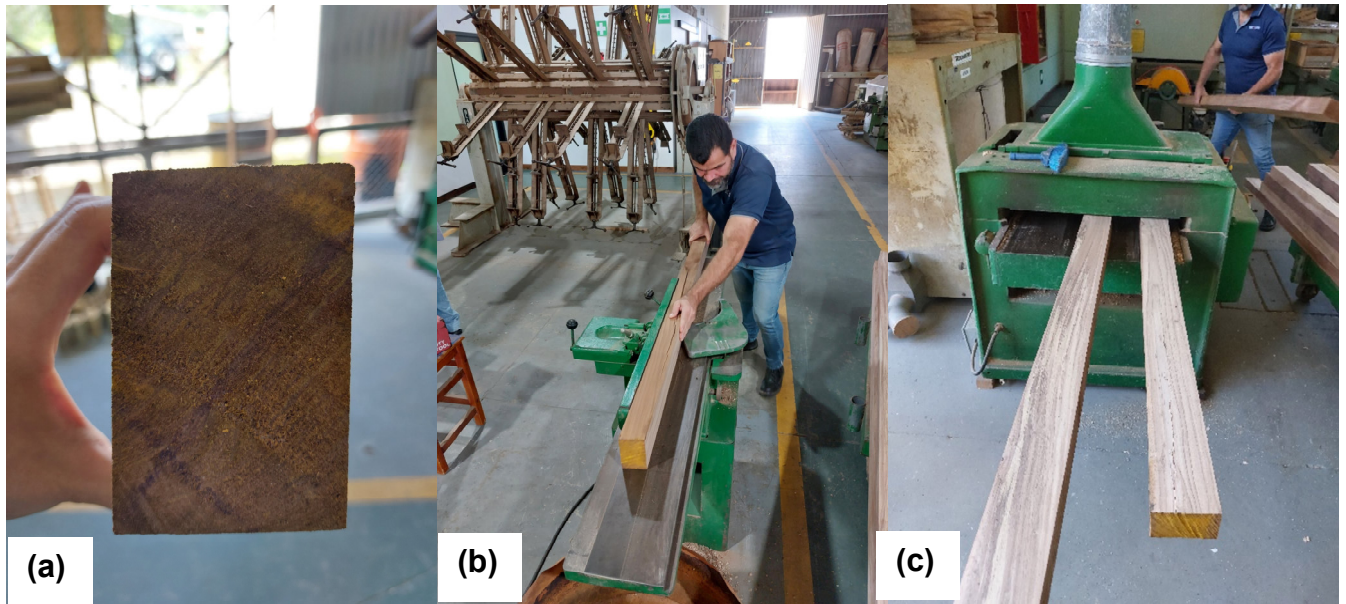
Figura 31. Procesamiento de la madera para obtener una sección de 65x90mm
