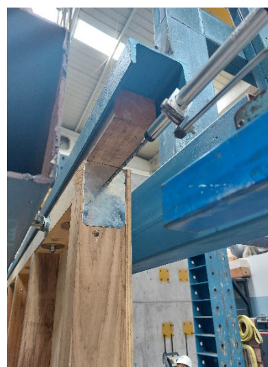
Figura 83. Colocación de platina metálica para correcto funcionamiento del LVDT1 en Muro 3
