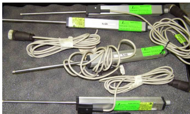
Figura 69. Transformadores diferenciales de variación lineal LVDT
