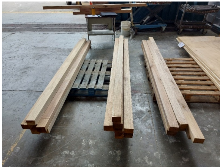
Figura 41. Madera clasificada según presencia de imperfecciones
