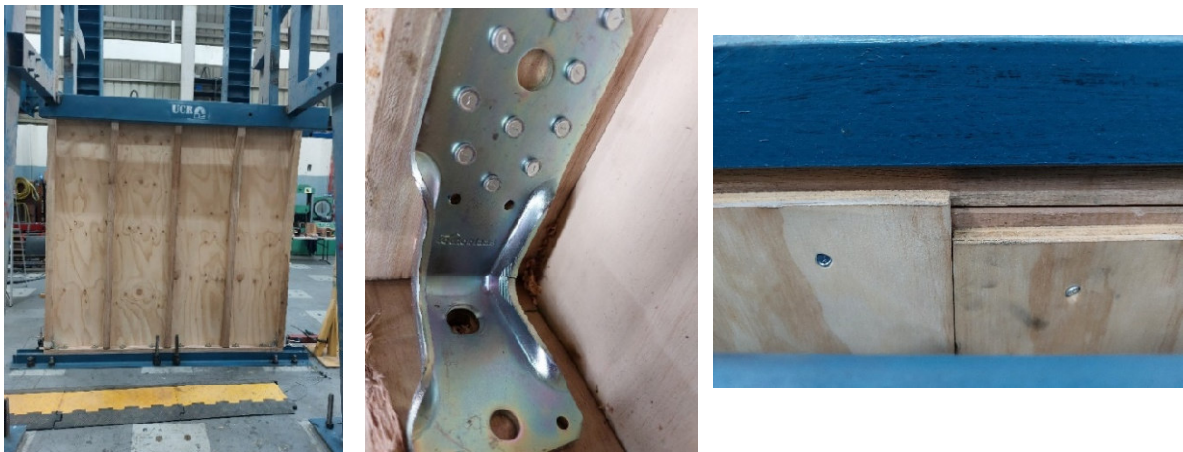
MURO 2: carga cíclica quasi-estática
