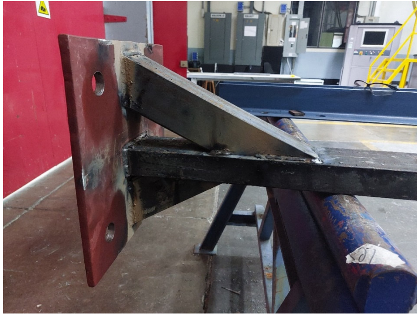
Figura 56. Refuerzos viga de carga
