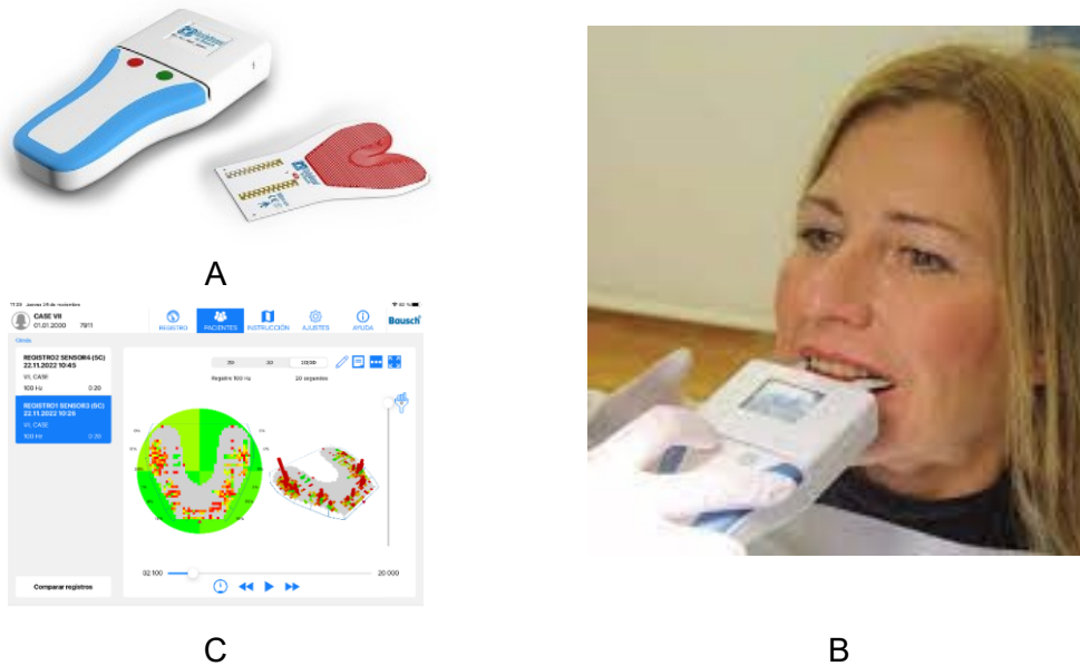
Iturria: Norberak egindakoa, [72] erreferentzietatik hartutako irudiak erabilia. 2-43. irudia. OccluSense sistema. A, OccluSense dispositiboa eta bere sentsorea. B, paziente bati hartutako erregistroa. C, software programa.
