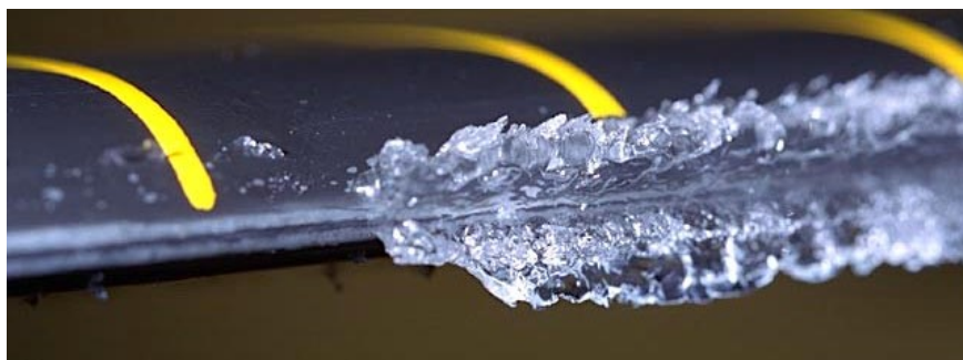
Figura 24. Formación de hielo tipo glaze ice .
