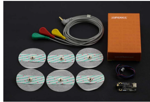
Irudia 6: DFRobot-ek garatutako EKG sentsorea ezkerrean eta harekin batera ekartzen dituen osagarriak eskuinean [33]
