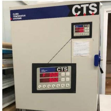
**Figura 13.** Horno climatizado con las condiciones de 90 % de humedad y 30 °C.
