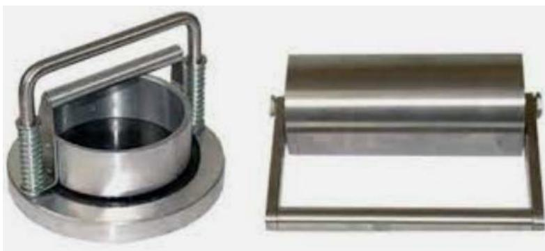
**Figura 11.** Anillo COBB y rodillo de 10 kg.
