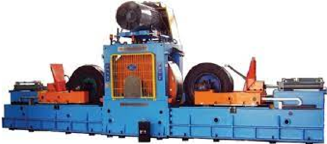
Figura 5: Máquina utilizada en los ensayos Endurance . Fabricante: RPM. Modelo: TJR2TBY. Especificaciones Técnicas: Anexo D
