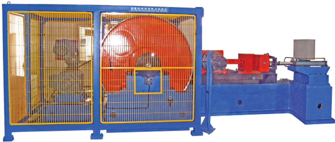
Figura 6: Máquina utilizada en los ensayos Rolling Resistance . Fabricante:RPM. Modelo: TJRRRTBY. Especificaciones Técnicas: Anexo D.
