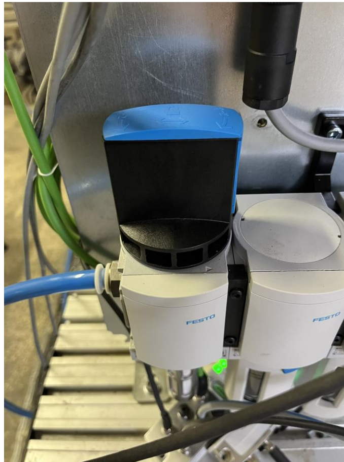
Figura 37. Segunda llave de paso del sistema. A la entrada del filtro de aire.
