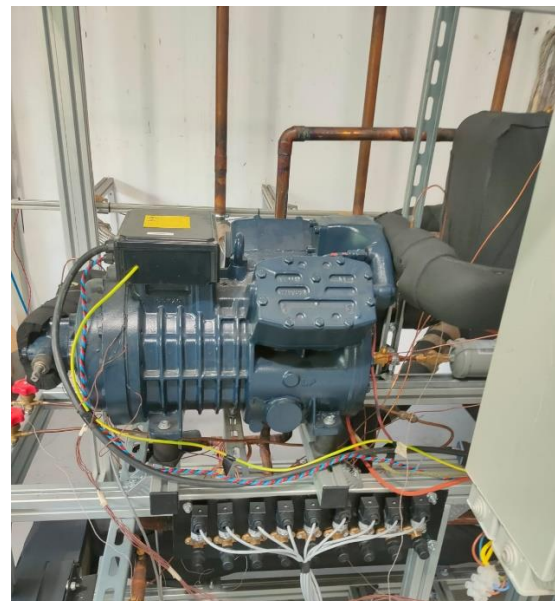
11. Irudia: Tecnaliak erabilitako HEEX1500CC konpresorea
