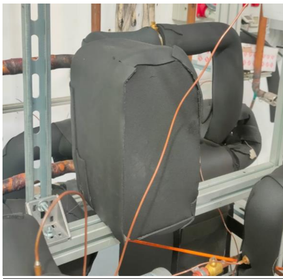
15. Irudia: Tecnaliak erabilitako SWEP B12Lx60/1P-SC-S bero trukagailua.
