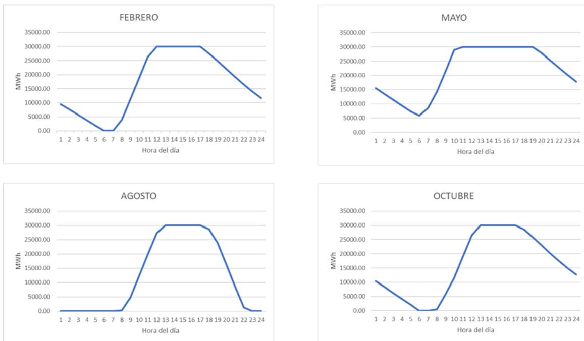
Ilustración 17. Carga y descarga TES con 69.595 módulos, 30MWh de capacidad de almacenamiento y 7500 kW de potencia.
