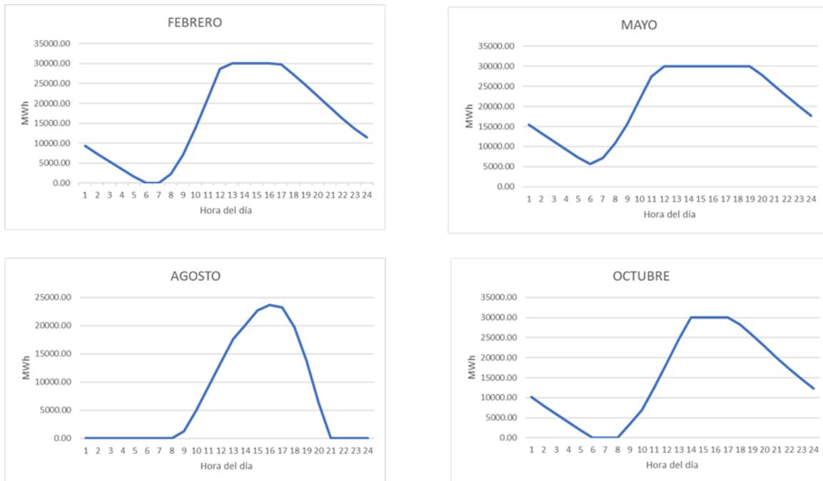
Ilustración 27. Carga y descarga TES con 52.196 módulos, 30MWh de capacidad de almacenamiento y 7500 kW de potencia.
