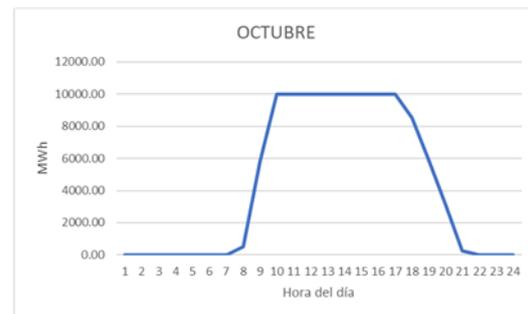
Ilustración 23. Carga y descarga TES con 69.595 módulos, 10MWh de capacidad de almacenamiento y 7500 kW de potencia.
