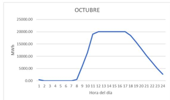
Ilustración 20. Carga y descarga TES con 69.595 módulos, 20MWh de capacidad de almacenamiento y 7500 kW de potencia.
