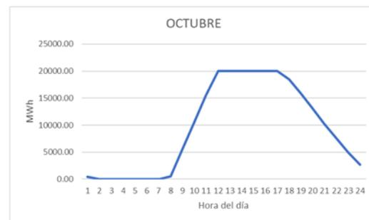
Ilustración 21. Carga y descarga TES con 69.595 módulos, 20MWh de capacidad de almacenamiento y 5000 kW de potencia.
