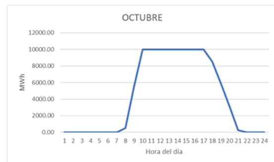
Ilustración 24. Carga y descarga TES con 69.595 módulos, 10MWh de capacidad de almacenamiento y 5000 kW de potencia.
