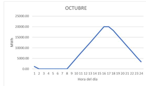
Ilustración 31. Carga y descarga TES con 52.196 módulos, 20MWh de capacidad de almacenamiento y 2500 kW de potencia.
