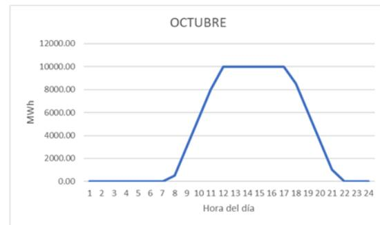
Ilustración 25. Carga y descarga TES con 69.595 módulos, 10MWh de capacidad de almacenamiento y 2500 kW de potencia.
