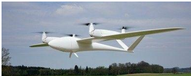
Figura 14. UAV híbrido (Quantum Systems Tron).
