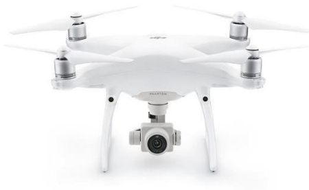
Figura 12. UAV de ala rotatoria (DJI Phantom 4 Pro).
