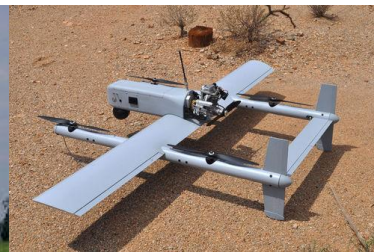
Figura 14. UAV híbrido (Quantum Systems Tron).
