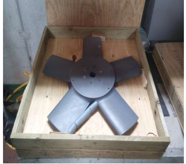
Fig. 3. Irudia. Wells turbinaren turbinak Mutriku olatu-instazioan
