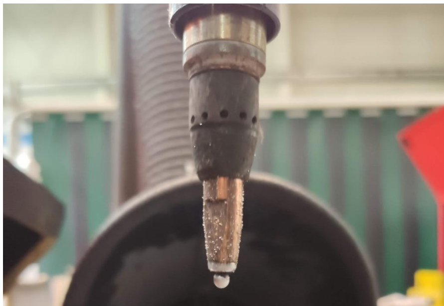
Figura 4.56: Embotamiento en la punta de contacto generado por una mala calidad superficial del hilo con la aleación Al-Zn-Mg-Cu.
