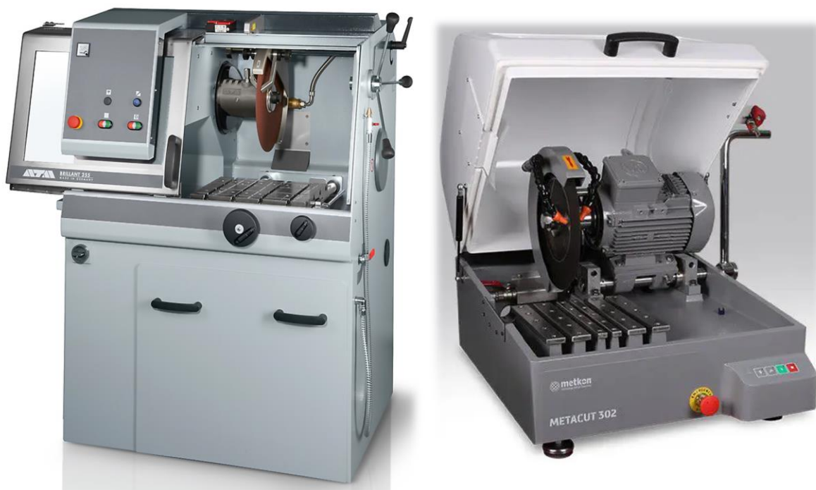
Figura 3.13: Cortadora de gran tamaño ATM Brillant 255 (Izq.) y cortadora de laboratorio METACUT 302 (Dch.).
