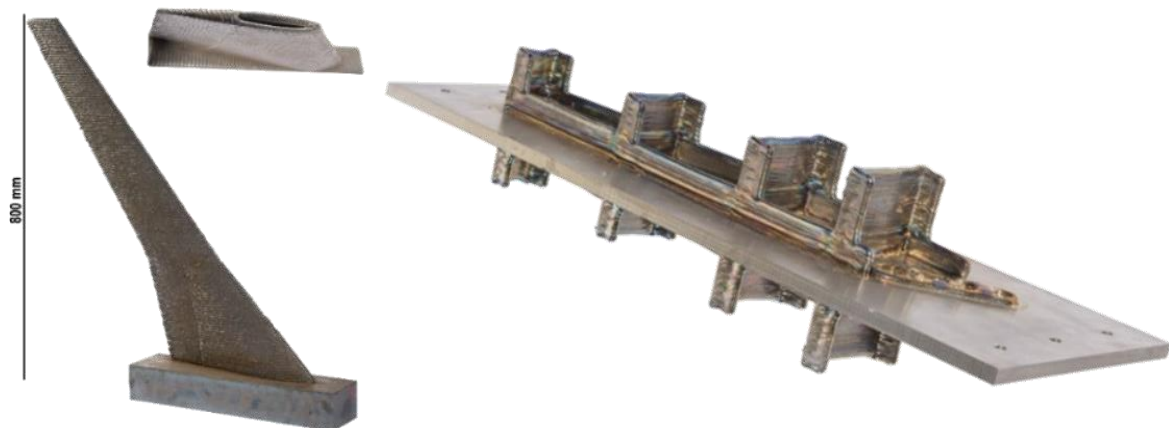
Figura 3.1: Ejemplo de pieza en el que el metal base no es parte de la pieza final (Izq.) y en el que es parte de la pieza final (Dch.) proporcionado por Cranfield University.
