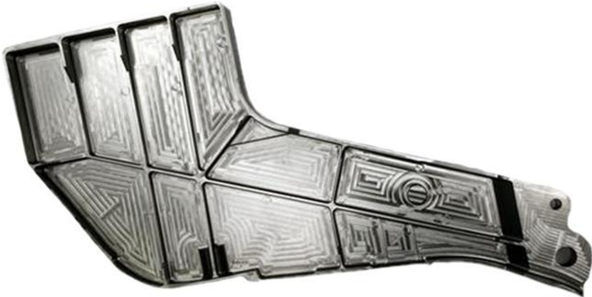
Figura 2.10: Elemento estructural principal de un ala de avión de titanio, de dimensión 1200 x 500 x 100 mm. Imagen de Cranfield University [24].
