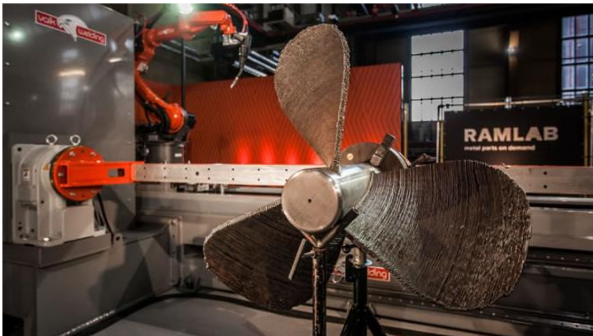
Figura 2.12: Hélice para aplicación marítima fabricada por Damen Shipyards de 1,3 m de diámetro y 180 kg de aleación de bronce [24]. Imagen de Delta Consultants.
