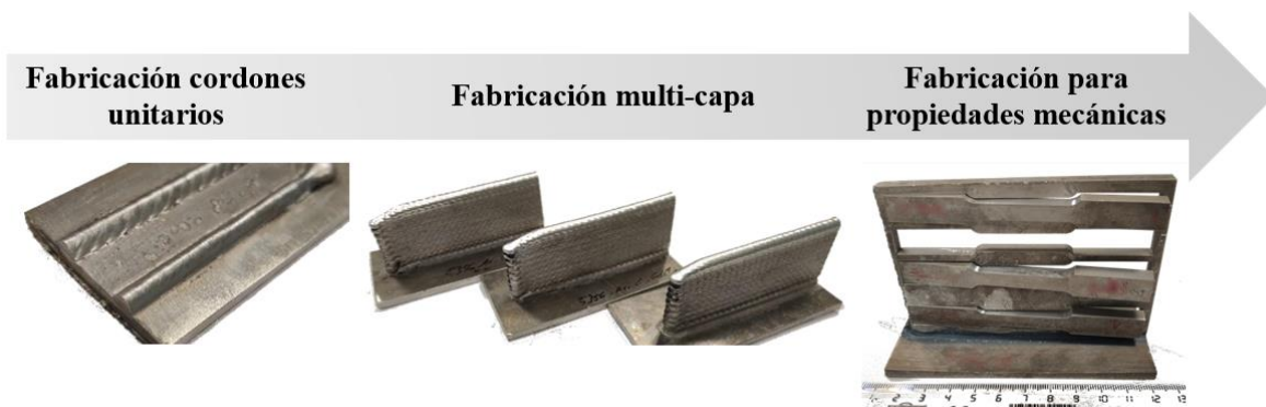
Figura 3.4: Metodología para selección de parámetros de fabricación.
