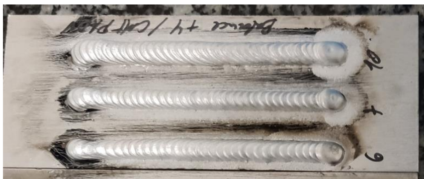
Figura 4.23: Parámetros eléctricos de la primera capa para asegurar un buen mojado entre el metal de aporte ER2319 y el metal base. De arriba abajo: 126 A, 103 A y 96 A (los parámetros de WFS y tensión son sinérgicos).
