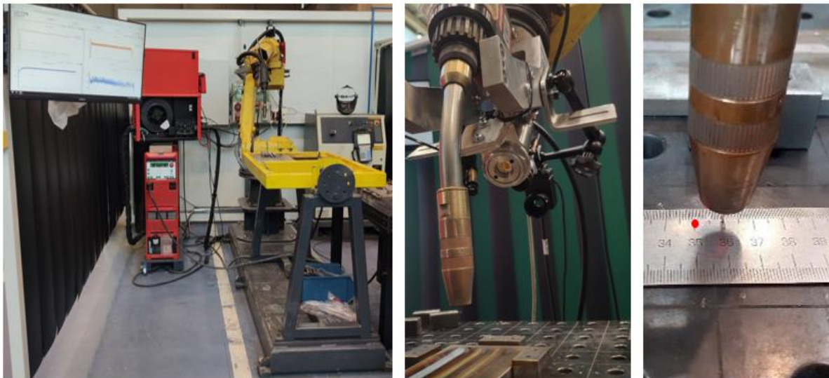
Figura 3.3: Características de la célula inteligente: (Izq.) Equipos de fabricación, fuente y brazo robótico. (Cen.) Configuración de la antorcha con el pirómetro. (Der.) Posicionamiento del láser del pirómetro respecto al centro del hilo.
