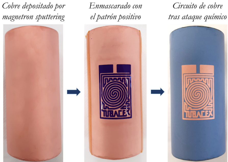
Figura IV.26. Proceso real de síntesis del circuito sensor de cobre mediante fotolitografía convencional.
