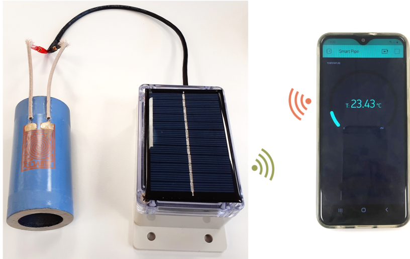
Figura VI.14. El nodo sensor, incluyendo al propio sensor, y el teléfono móvil que recoge la información de la medida.
