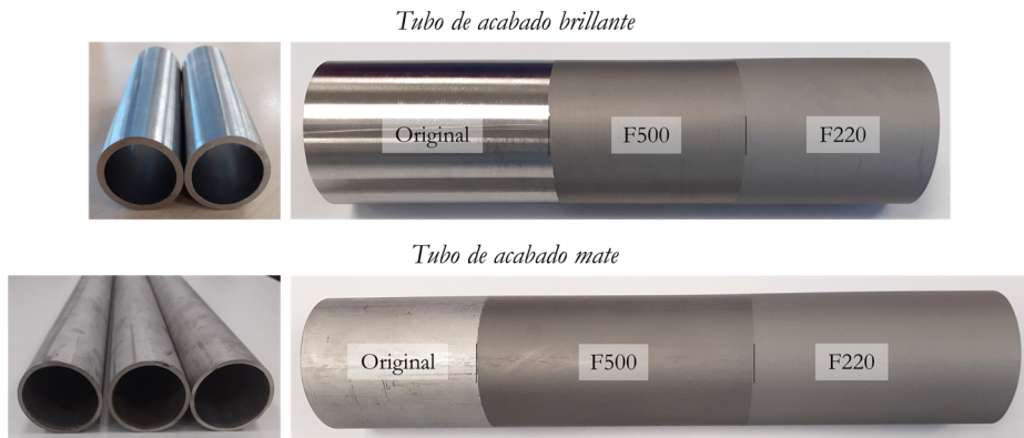
Figura III.25. Tubos de acabado brillante y acabado mate, antes (izquierda) y después (derecha) de los tratamientos superficiales.
