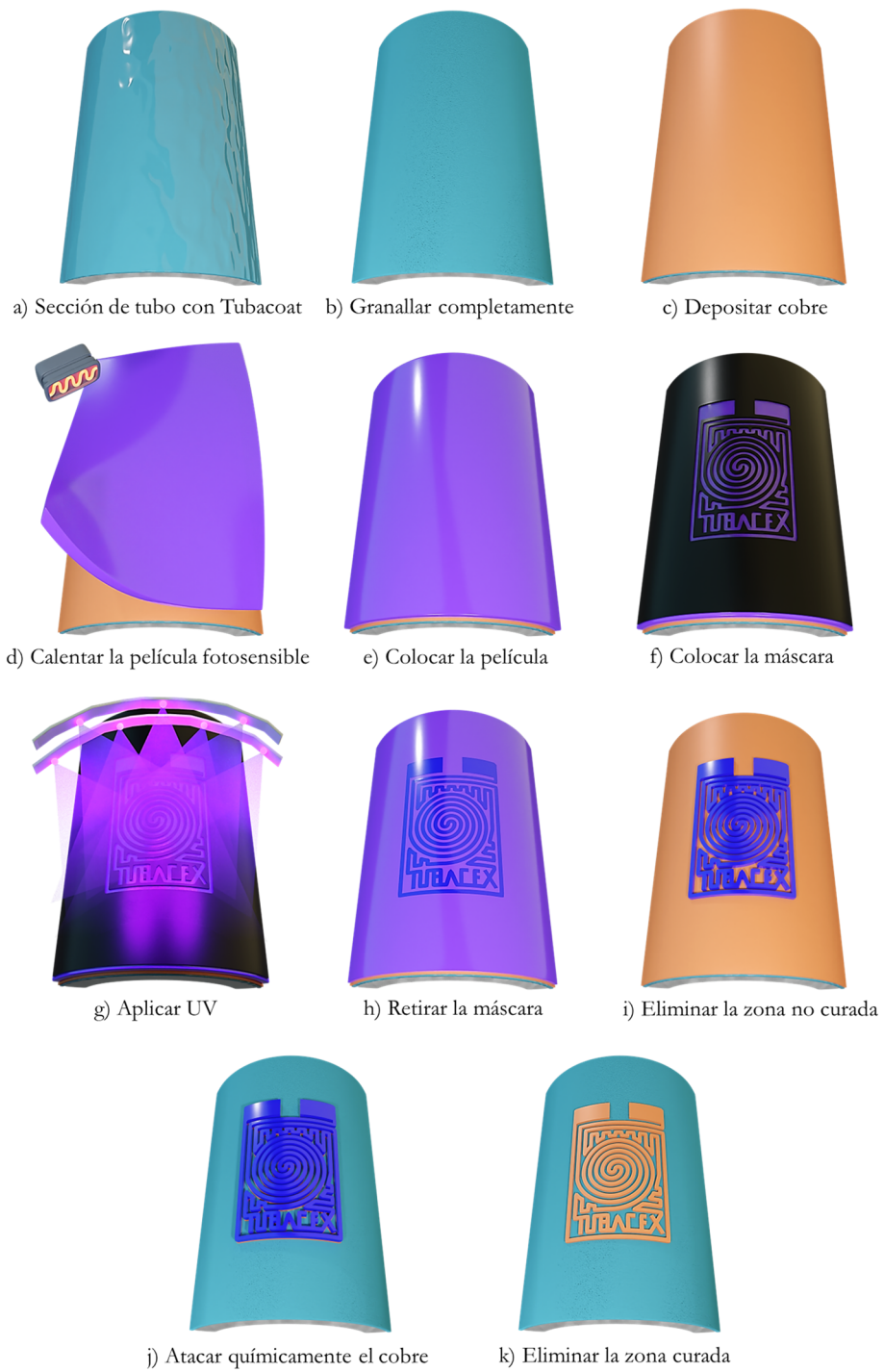
Figura IV.19. Proceso de fabricación de la capa sensora por fotolitografía.
