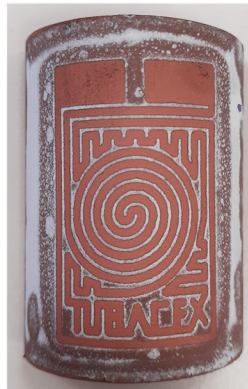
Figura III.13. Sensores fabricados sobre la alúmina de proyección térmica.
