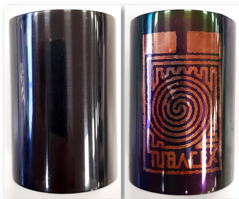
Figura III.41. Tubo con capa protectora de óxido de silicio (izquierda). Sensor de cobre sobre lo anterior (derecha).
