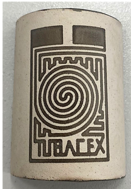
Figura III.13. Sensores fabricados sobre la alúmina de proyección térmica.
