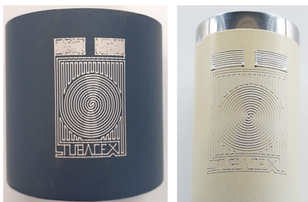
Figura IV.8. Sensores basados en tinta de plata sobre Tubacoat (izq.) y cerámica por sol-gel (dcha.)
