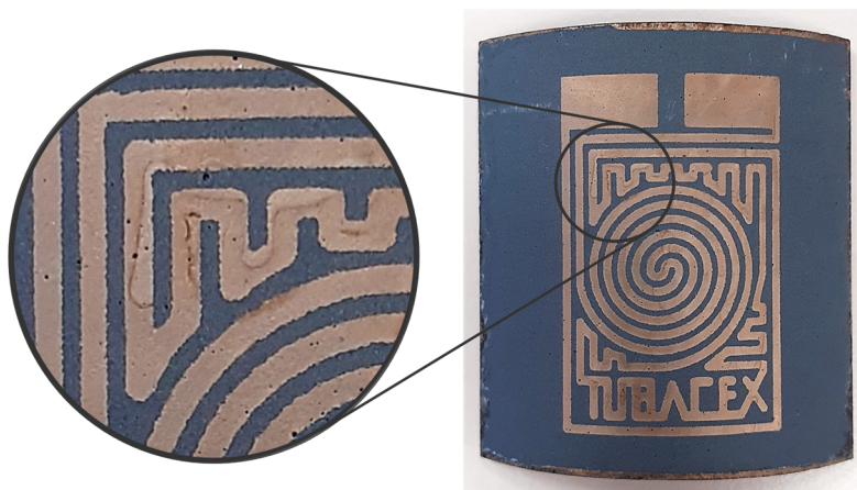
Figura IV.36. Sensor de níquel por electroless tras su fabricación.
