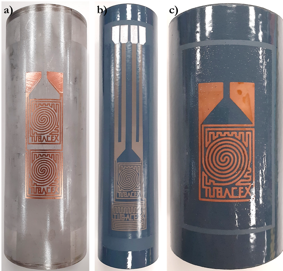
Figura V.11. Demostradores de sensores embebidos sobre tubos.
