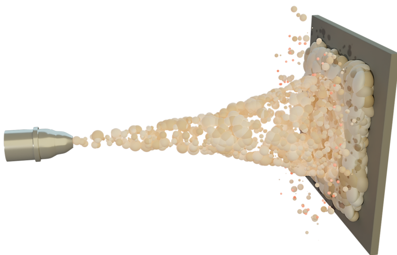
Figura II.41. Proyección térmica sobre sustrato plano.
