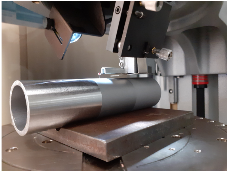
Figura III.26. Caracterización de las rugosidades tras los tratamientos superficiales sobre tubo brillante mediante perfilometría de contacto.
