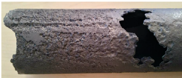
Figura III.5. Evidencias de fallo por corrosión en un tubo real.
