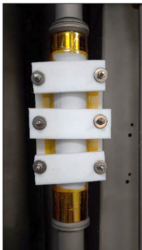
c.) Sistema de sujeción de las máscaras
