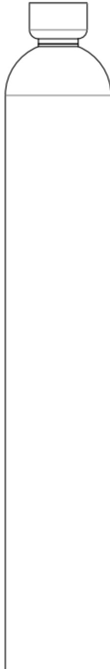
Ilustración 16 Botellón, debe pintarse en color rojo por norma UNE-EN 1089-3:2011; que debe llevar por ser portador de hidrógeno. Debe pintarse la ojiva y el cilindro de rojo.
