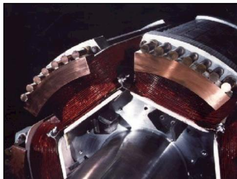
*Figura 13: Devanados del rotor con bobinado amortiguador [12].*
