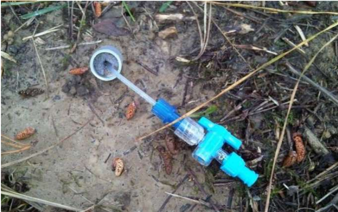
4.3.- Irudia:- MicroRhizonaren ageriko zatia. Hutsa eginez poroetako ura erauzteko erabili ohi den xiringa lotzen zaioneko giltza. Ikusgai ez dagoen zatia lur azpian dago eta 30 cm-ko sakonerararte iristen da.
