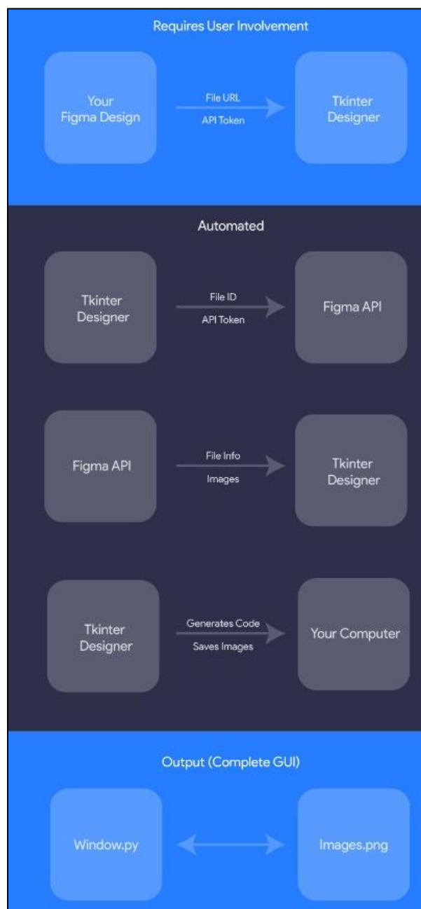
Ilustración 40: Diagrama de funcionamiento de "Tkinter-Designer"
