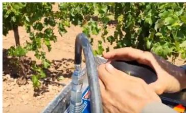
3) Abrimos la llave del manómetro al que está conectada la cámara de presión (o nos aseguramos de que está abierta).
