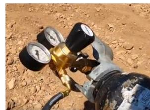
4) Posicionamos la válvula horizontal en posición "chamber" para así permitir que el aire comprimido en la botella vaya pasando poco a poco a la cámara donde está la hoja. La "valve rate" controla la rapidez con la que sube la presión, que idealmente debe fijarse a 1 mBar por segundo.
