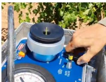
5) Observar el corte del peciolo atentamente y justo cuando veamos la sabia salir por el xilema del corte, posicionar la válvula horizontal en "OFF" para detener la entrada de aire.
