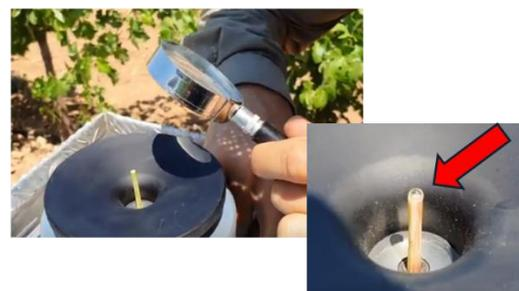
6) Realizar la lectura de la presión de la cámara. La foto del ejemplo indica -12 Bares (o -1,2 MPA). Recuerda que la presión de la cámara es positiva, pero la de la hoja es negativa, es decir, -1,2 MPa es la presión con la que el agua está retenida en el tejido, puesto que se requiere de una presión positiva de +1,2 MPa para superarla y extraer ese agua.
