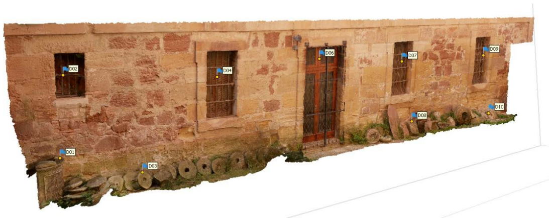
Fig. 38.- Distribución de las dianas (puntos de apoyo) que sirven para dar escala al modelo 3D del patio.
