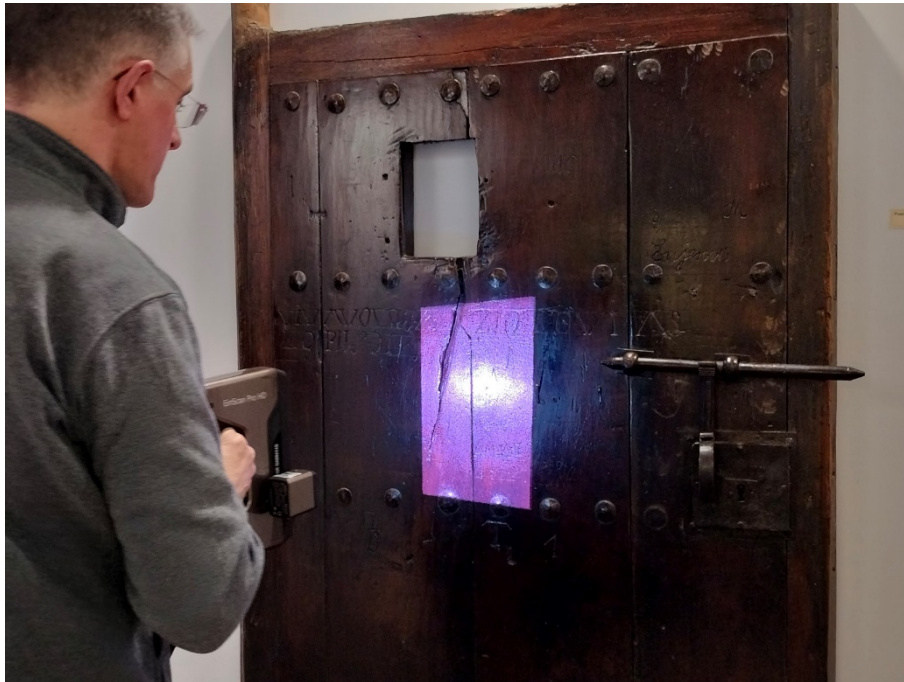
Fig. 8.- Registro de datos (escaneado 3D) de una de las puertas del museo Najerillense.
