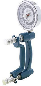
Figura 16. Hand grip hidráulico Jamar Sammons Preston.
