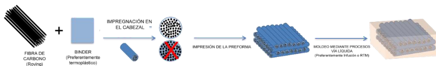
Figura 2.34: Flujo de procesos involucrados en la tecnología de Preformado Aditivo de CFCs.
