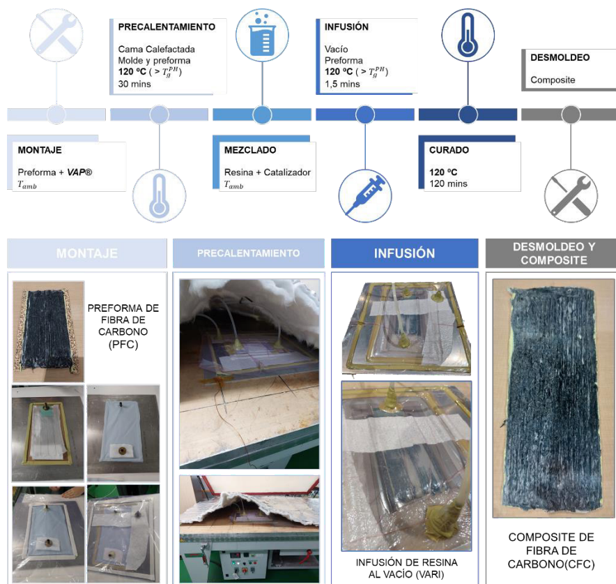
Figura 6.22: Parámetros del proceso de infusión y etapas involucradas en el proceso.
