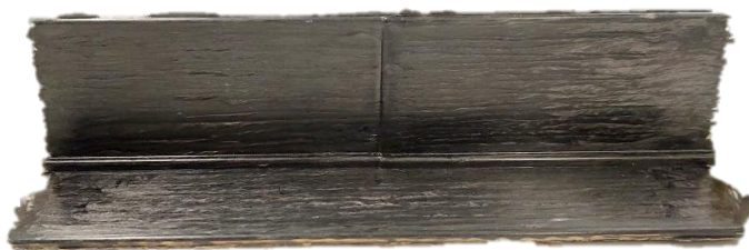
Figura 6.30: Composite PH/CFC-2 b fabricado a partir de la PH/PFC-2 b.
