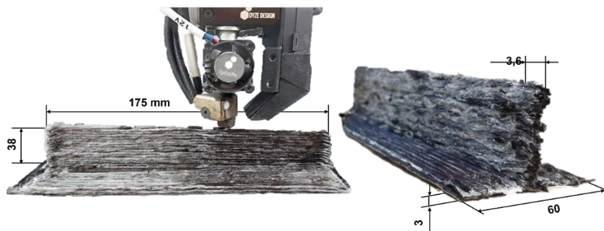
Figura 6.31: Proceso de Preformado Aditivo de la PH/PFC-3 a partir de los filamentos de FCC recubiertos con PH como sus dimensiones principales.
