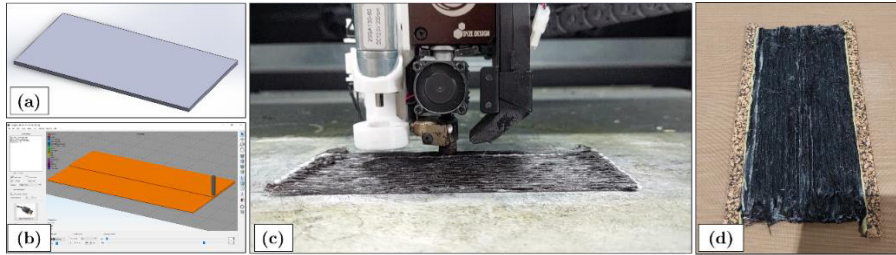
Figura 6.20: Fabricación de láminas a partir de las cuales se obtendrán probetas de flexión y tracción: Modelo CAD de la preforma (a), archivo Gcode (b), proceso de impresión (c) y PH/PFC (d).
