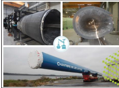
Figura 2.5: La fabricación del mástil se basa en preregs de carbono fabricadas en autoclave [17].
