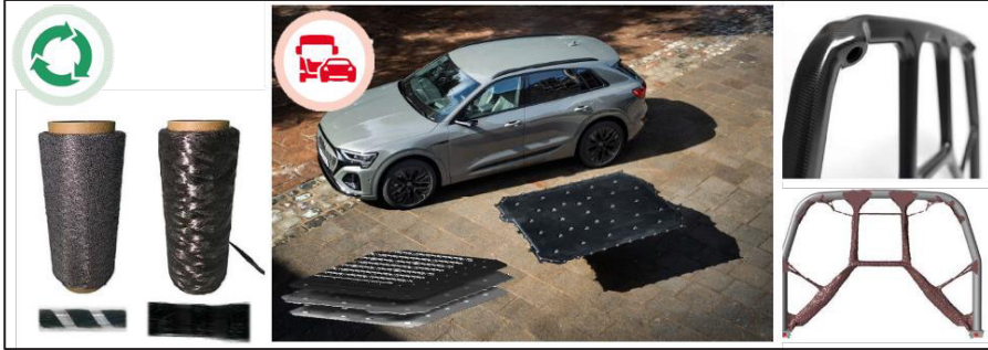
Figura 2.7: De izquierda a derecha; el hilado de fibra de carbono 100% reciclado es compatible con el proceso de pultrusión; guardabarros trasero diseñado con un sandwich termoplástico; jaula antivuelco de carbono de peso extremadamente ligero [17].
