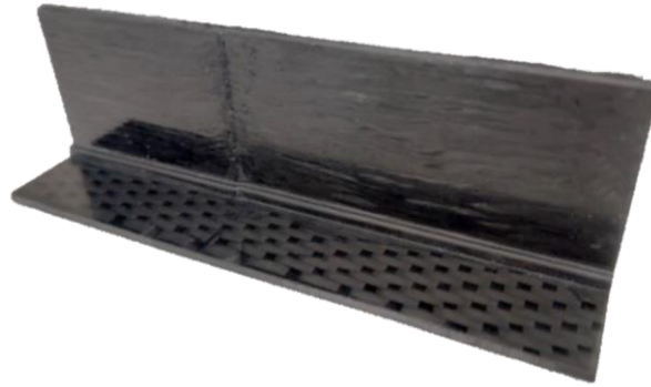
Figura 6.34: Composite PH/CFC-4 fabricado a partir de la PH/PFC-4.
