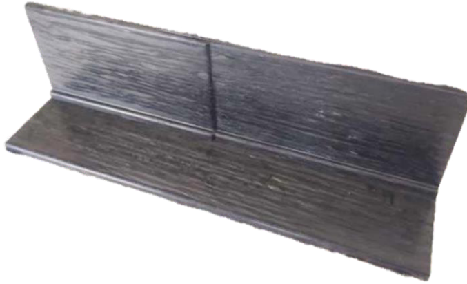
Figura 6.32: Composite PH/CFC-3 fabricado a partir de la PH/PFC-3 .
