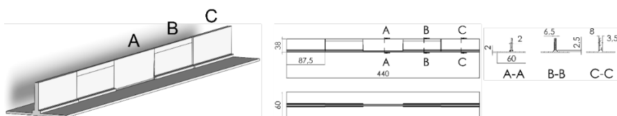
Figura 6.1: Modelo CAD de la geometría de la barra con perfil en T y dimensiones.
