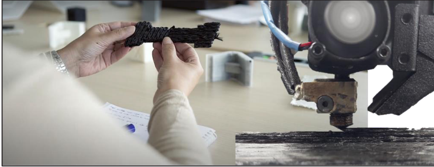
Figura 2.33: Preforma fabricada y su respectivo proceso de impresión del filamento de FCC.
