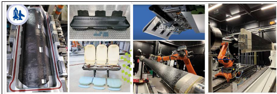
Figura 2.6: A la izquierda, estructura de asientos híbridos para aviones, basada en un material compuesto ligero y fácil de reciclar. A la derecha, el innovador flap Krueger, fabricado utilizando un proceso de consolidación termoplástica in-situ [17].
