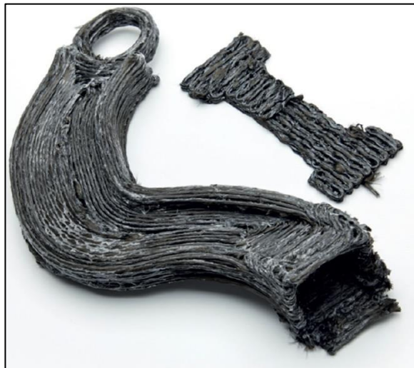
Figura 2.37: Preforma impresa mediante fabricación aditiva de fibra continua.
