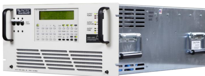
Figura 5-11. Fuente AC trifásica Pacific 320 AMX.
