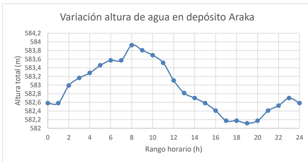
FIGURA 16. VARIACIÓN DE ALTURA TOTAL DE LOS DEPÓSITOS DE ARAKA.
