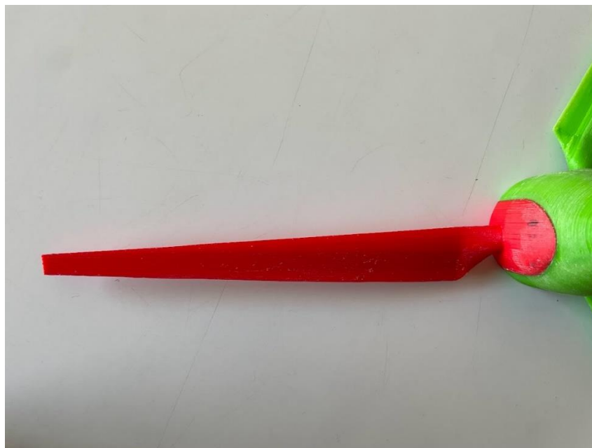
Figura 34: Pala impresa horizontalmente.
