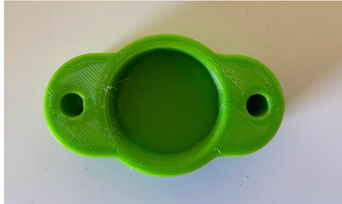
Figura 24: Pieza impresa en 3D para anclar el eje de la turbina al soporte de acrílico.
