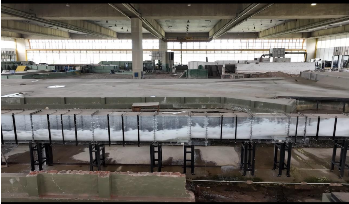
Figura 12: Sector de aireadores del modelo físico.
