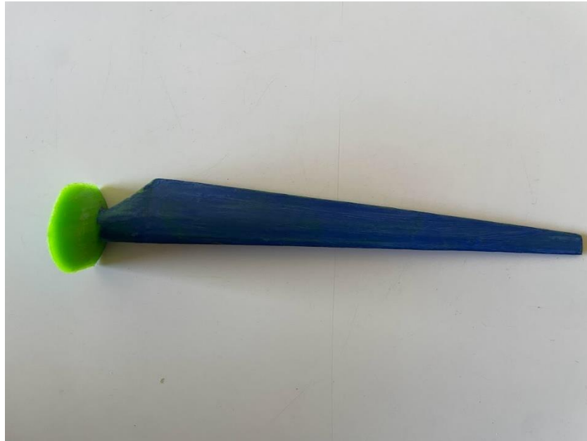
Figura 35: Pala postprocesada con esmalte de uñas.
