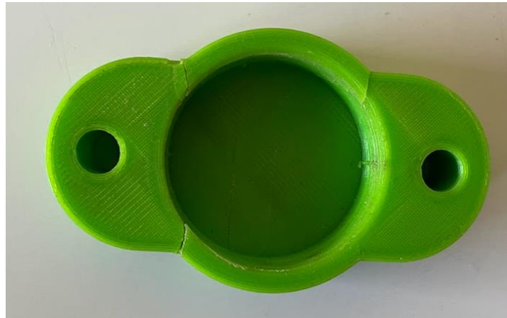
Figura 33: Soporte del eje con roturas.
