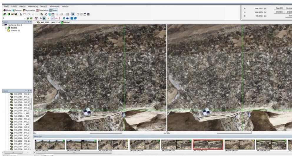
Fig. 18.- Par estereoscópico formado y proceso de restitución.
