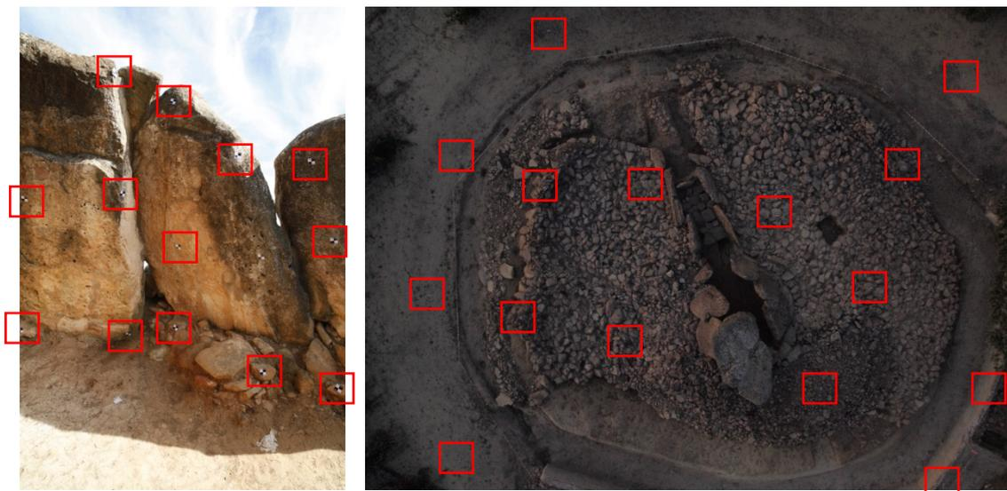
Fig. 4.- Distribución de las dianas utilizadas como puntos de apoyo fotogramétrico.
