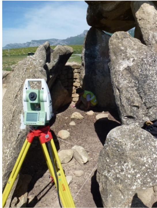
Fig. 8.- Replanteo de la cuadrícula en el interior de la cámara.
